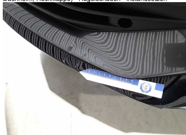
Beschädigung #3: Stossfänger vorn: Stossfänger vorn (inklusive Blende erneuern) - verformt - erneuern
