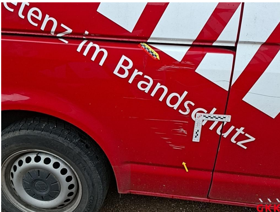
Bild 22. Seitenwand rechts, unterhalb, beschädigt, instand setzen - lackieren
