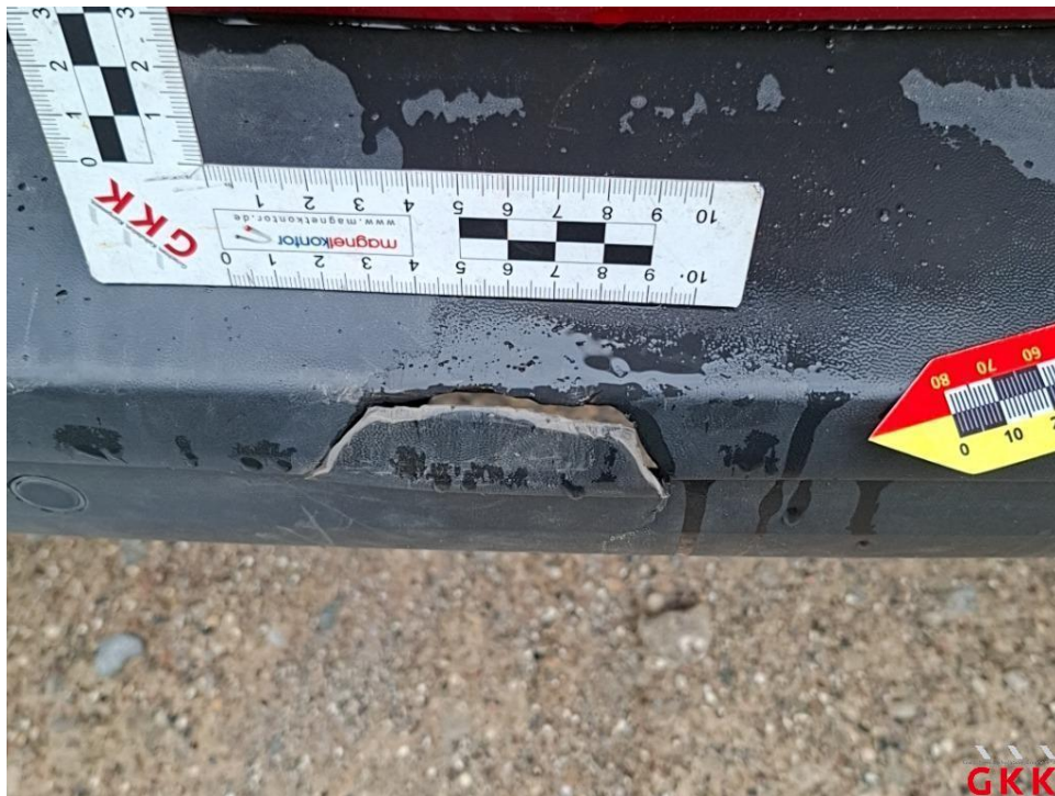
Bild 26. Stoßfänger hinten, Verkleidung -unlackiert-, gerissen, ersetzen
