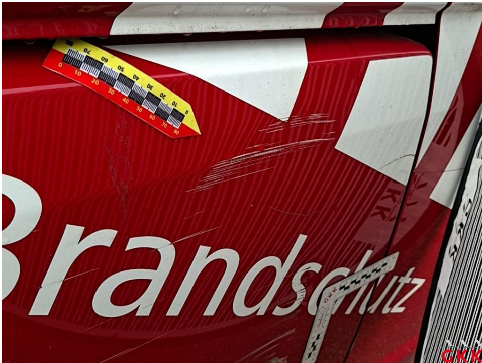
Bild 24. Seitenwand rechts, unterhalb, beschädigt, instand setzen - lackieren
