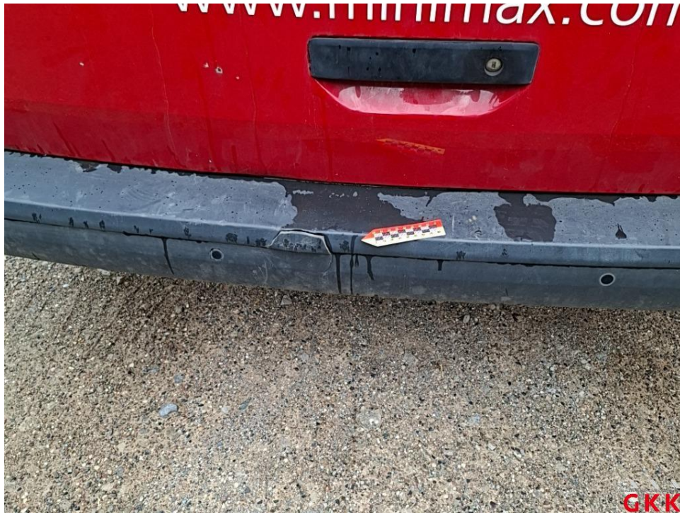
Bild 25. Stoßfänger hinten, Verkleidung -unlackiert-, gerissen, ersetzen
