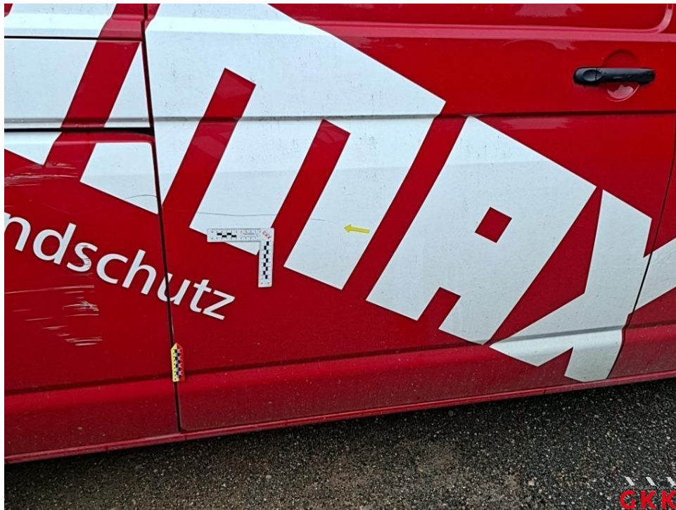
Bild 19. Schiebetür rechts, verkratzt, lackieren
