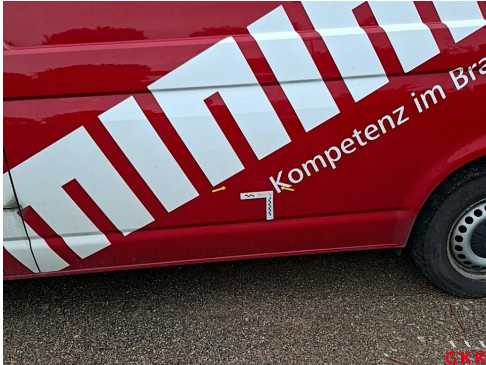
Bild 35. Seitenwand links, unterhalb, verkratzt, lackieren
