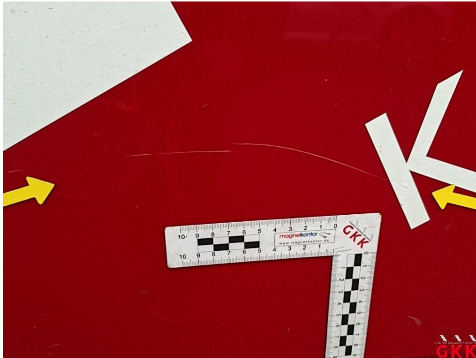
Bild 36. Seitenwand links, unterhalb, verkratzt, lackieren
