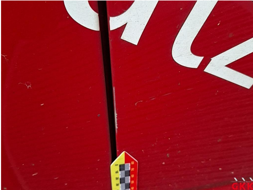
Bild 21. Schiebetür rechts, verkratzt, lackieren
