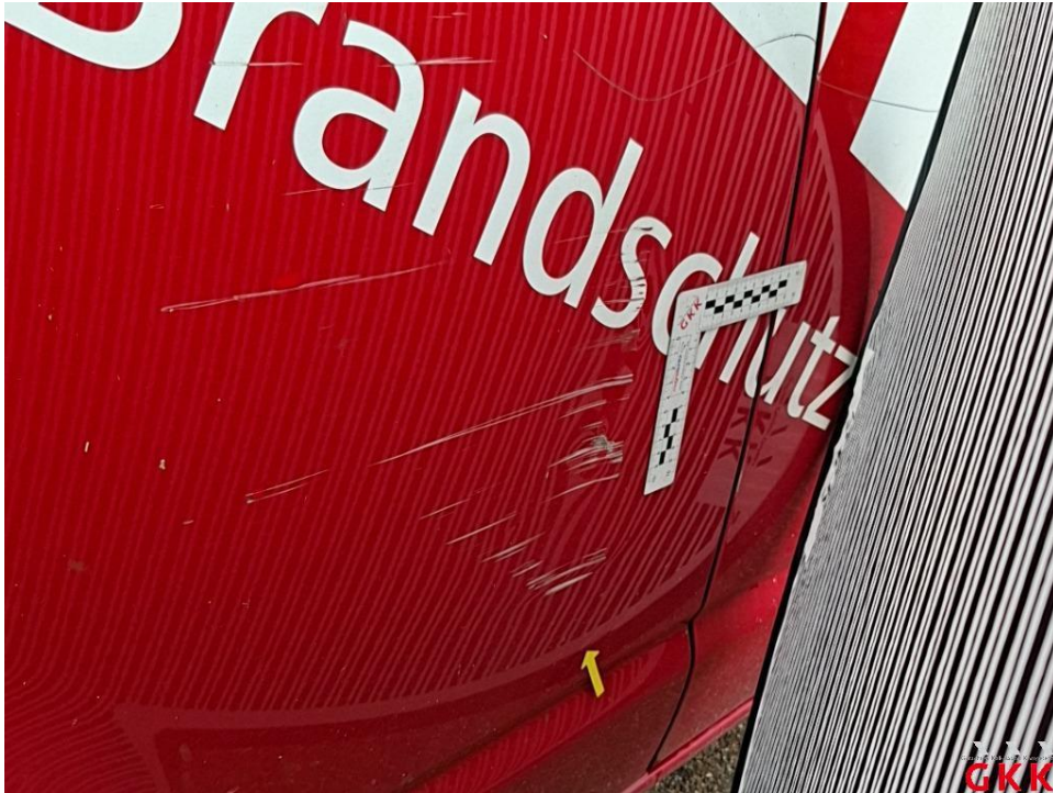
Bild 23. Seitenwand rechts, unterhalb, beschädigt, instand setzen - lackieren
