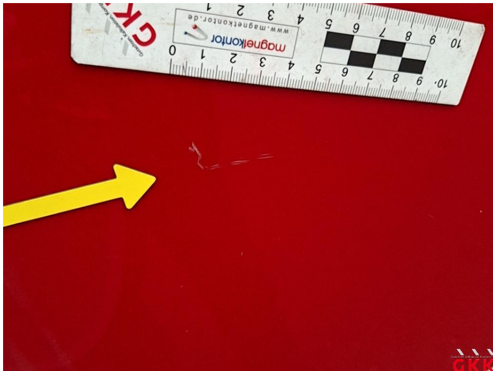
Bild 38. Tür vorne links, verkratzt, lackieren
