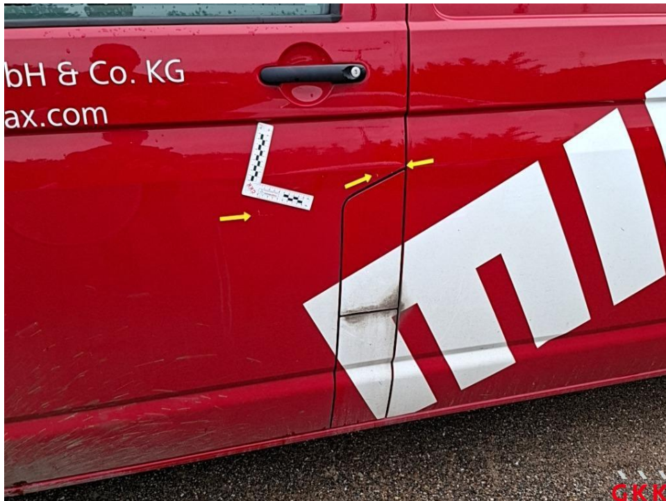
Bild 37. Tür vorne links, verkratzt, lackieren
