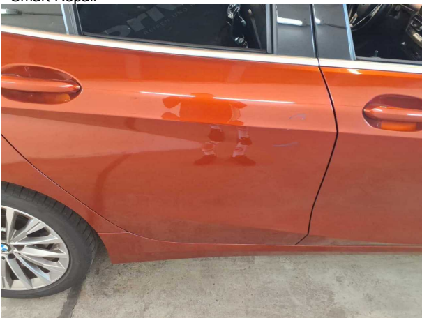
Beschädigung #3: Tür hinten rechts: Tür - verkratzt / versch... - instandsetzen und lackieren
