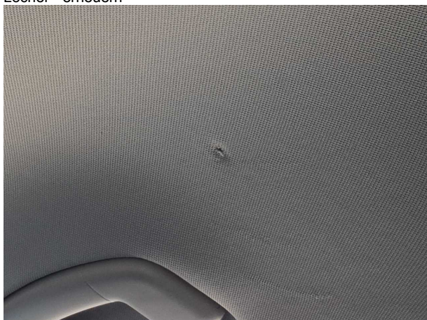
Beschädigung #3: Verkleidungen/Abdeckungen: Dachhimmel - Löcher - erneuern
