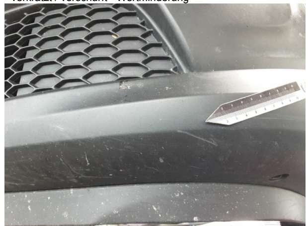
Beschädigung #2: Stossfänger vorn: Stossfänger vorn (unlackiert) - verkratzt / verschürft - Wertminderung
