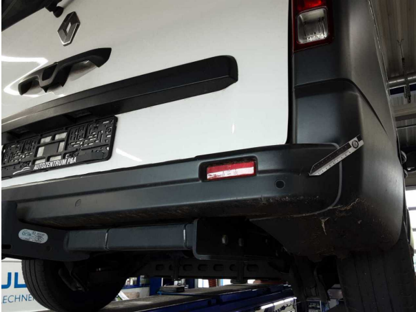
Beschädigung #1: Stossfänger hinten: Stossfänger hinten (unlackiert) - verkratzt / verschürft - Wertminderung
