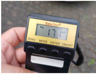
Lackstärke Seitenwand hinten links
