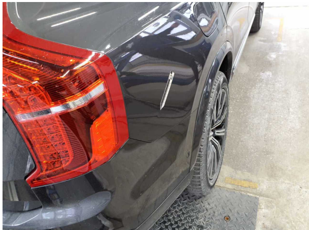
Beschädigung #1: Seitenwand rechts: Seitenwand - Delle(n) - sanft instandsetzen
