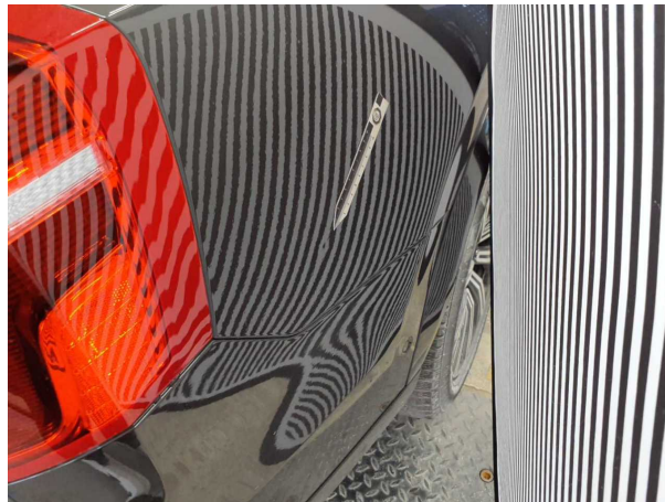
Beschädigung #1: Seitenwand rechts: Seitenwand - Delle(n) - sanft instandsetzen
