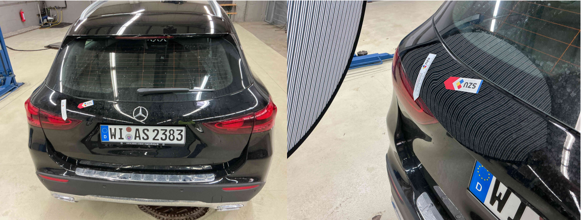
Heckklappe Delle aussen nach innen Smart-repair Mehraufwand 150€
