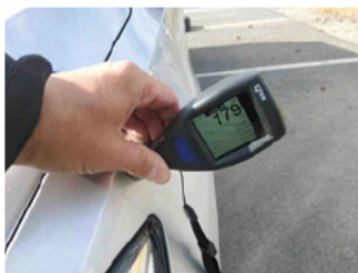
Lackstärke Kotflügel vorne links
