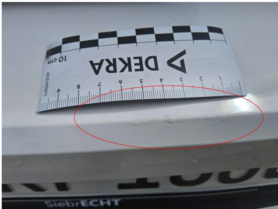
Bild 14 : Stoßfänger hinten Lackierung, fleckig, lackieren
