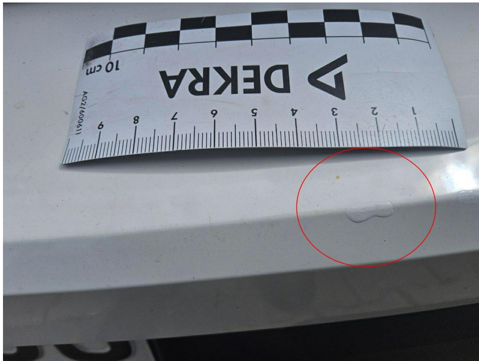
Bild 13 : Stoßfänger hinten Lackierung, fleckig, lackieren
