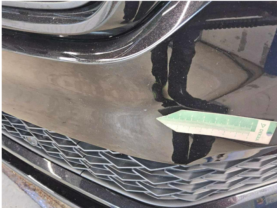
Bild 23 : Stoßfänger vorne Lackierung, Umweltschaden, lackieren
