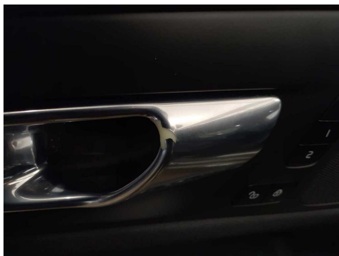
Damage 4: Door - front left side: Door handle - inside (Beschichtung) - Paint defect - Replace
