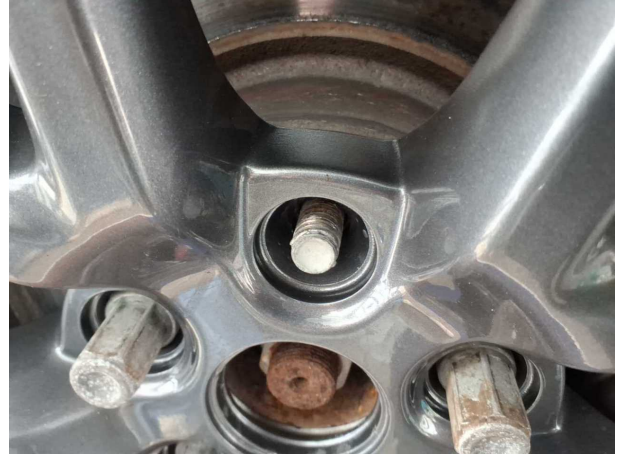
Beschädigung #1: Vorderachse: Radnabe links (Radbolzen inkl. Radmutter) - beschädigt - instandsetzen
