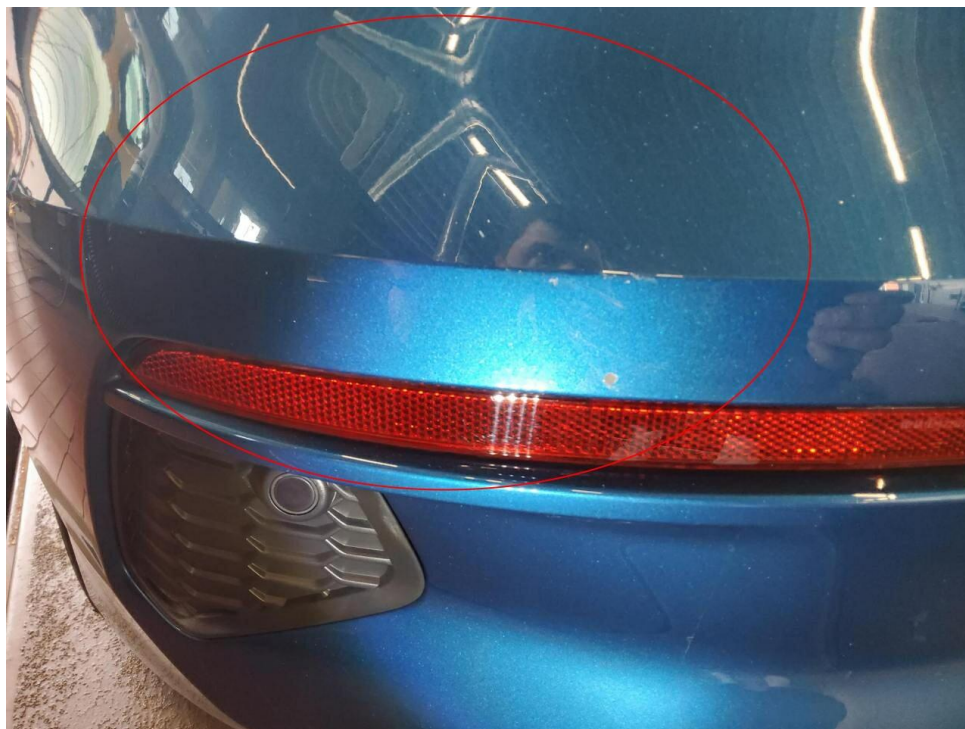
Bild 19 : Stoßfänger hinten Lackierung, zerkratzt, lackieren mit Lackaufbau
