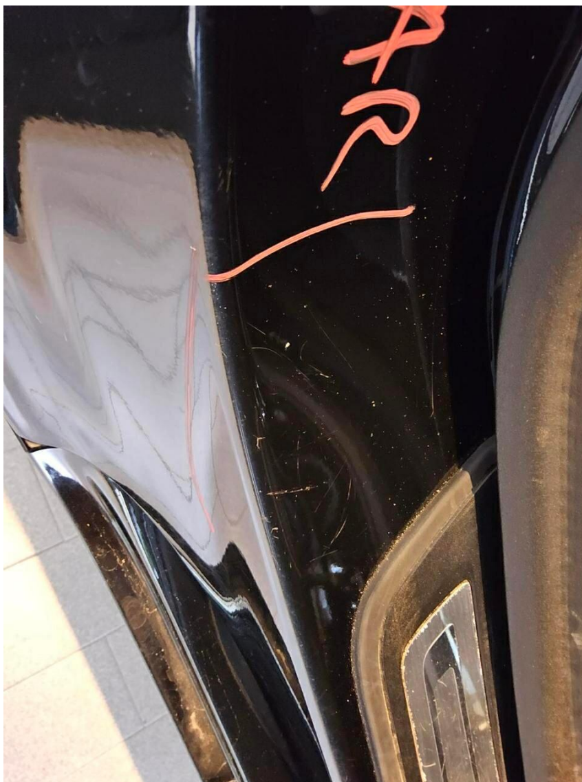
Bild 18 : Tür hinten rechts Einstieg Lackierung, zerkratzt, smart repair
