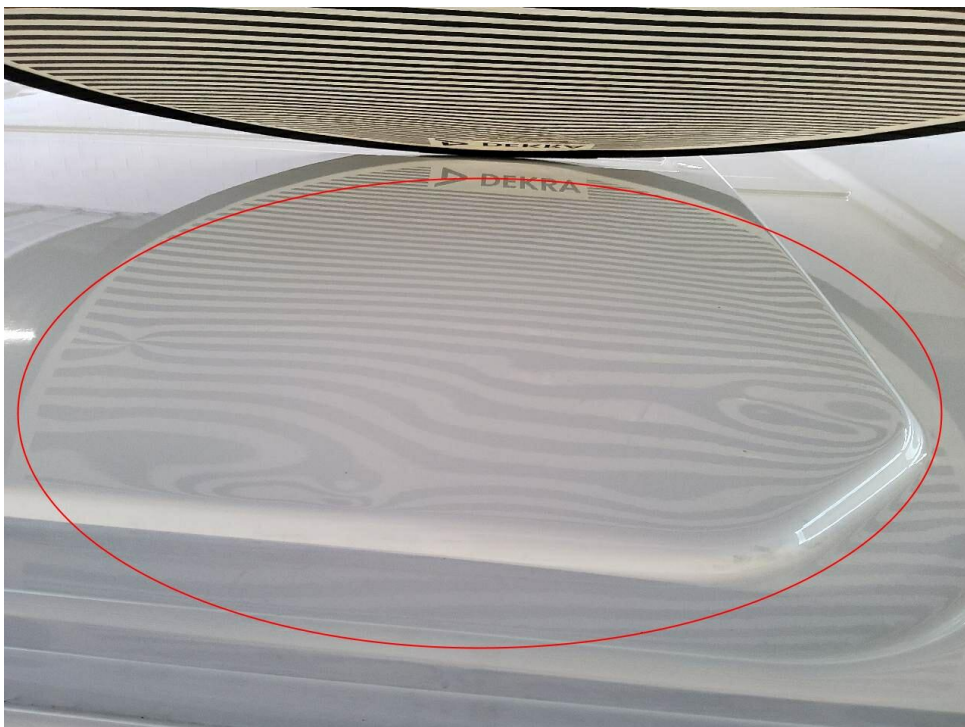
Bild 22 : Dach, mehrfach großflächig eingedellt
