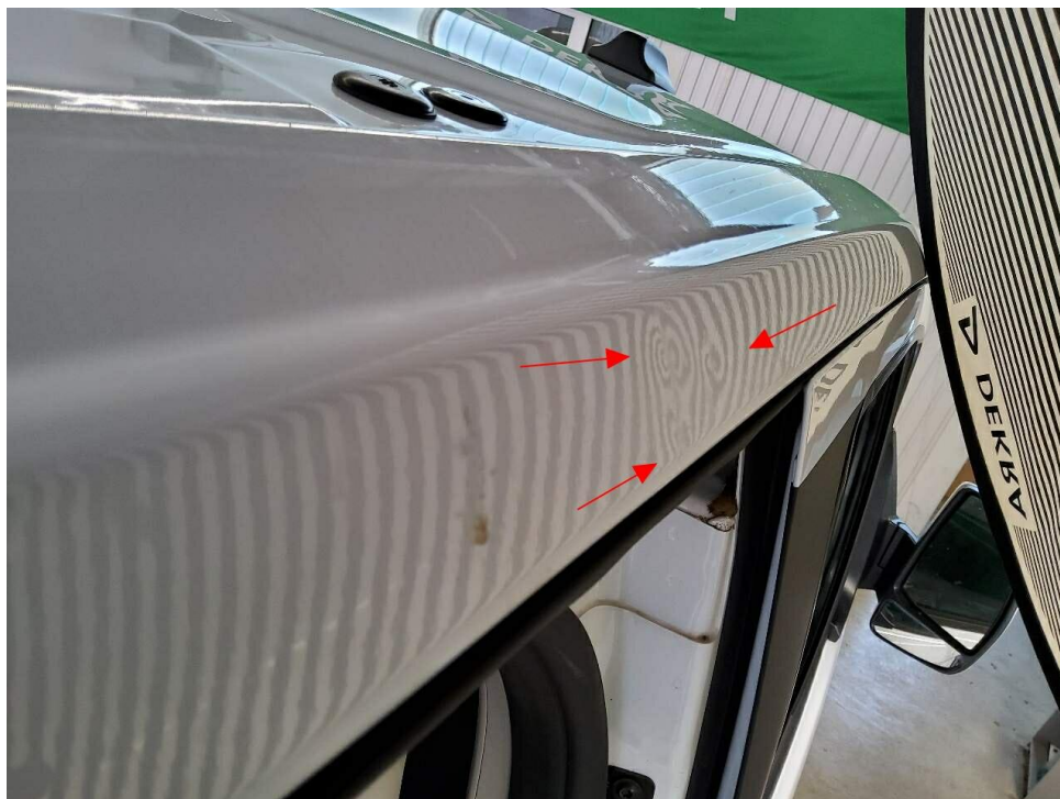
Bild 18 : Dachrahmen rechts, mehrfach eingedellt
