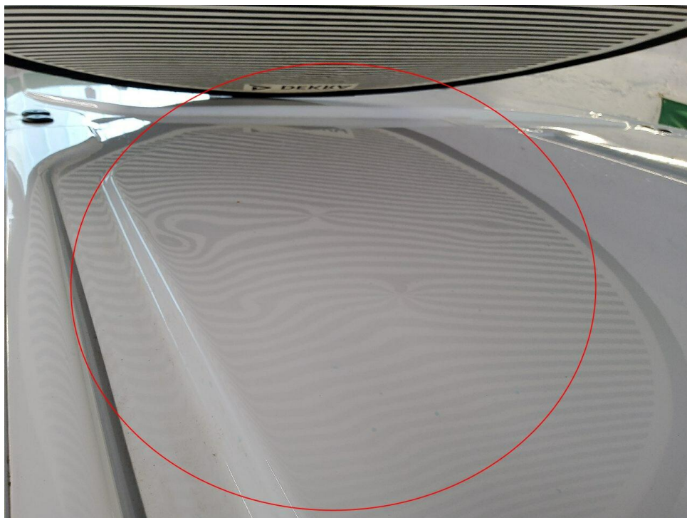
Bild 26 : Dach, mehrfach großflächig eingedellt
