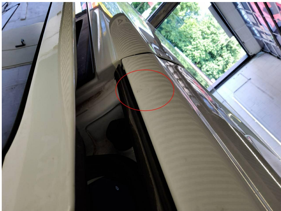
Bild 16 : Dachrahmen rechts, mehrfach eingedellt
