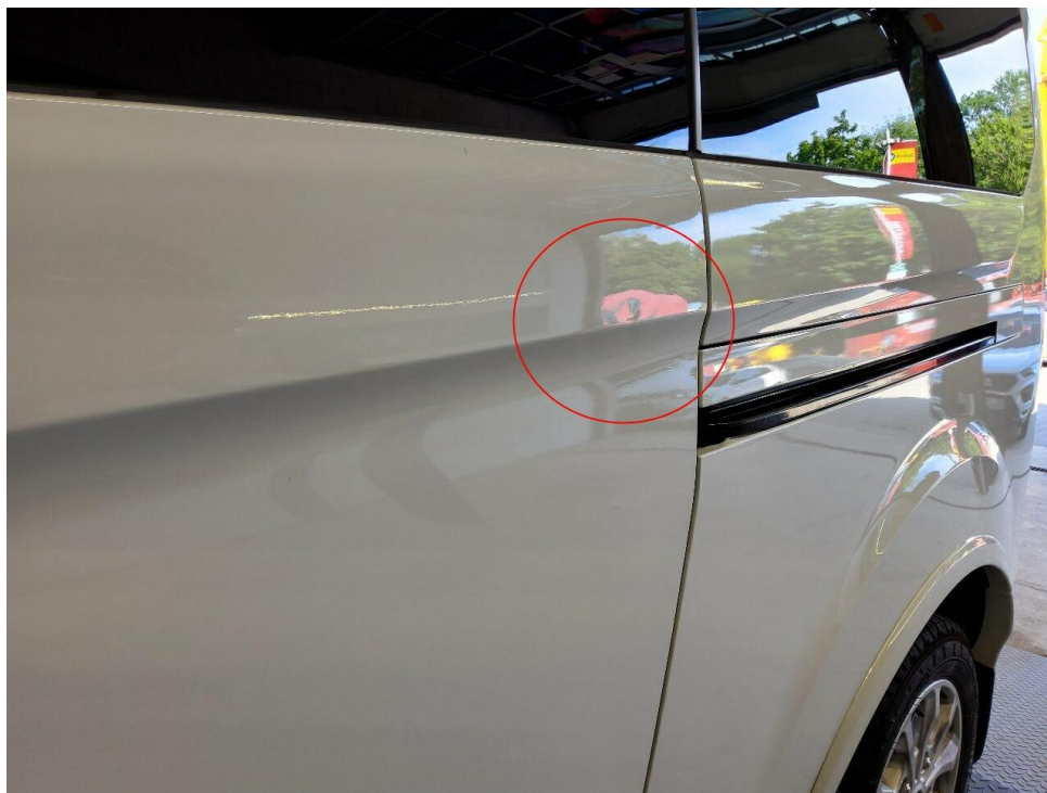
Bild 14 : Schiebetüre links, eingedellt
