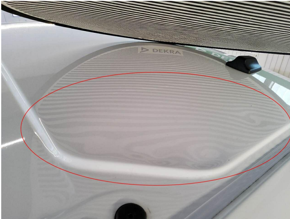
Bild 23 : Dach, mehrfach großflächig eingedellt
