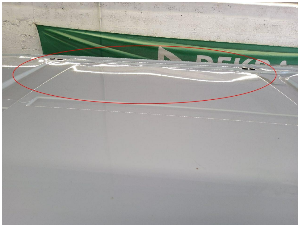
Bild 19 : Dach, mehrfach großflächig eingedellt
