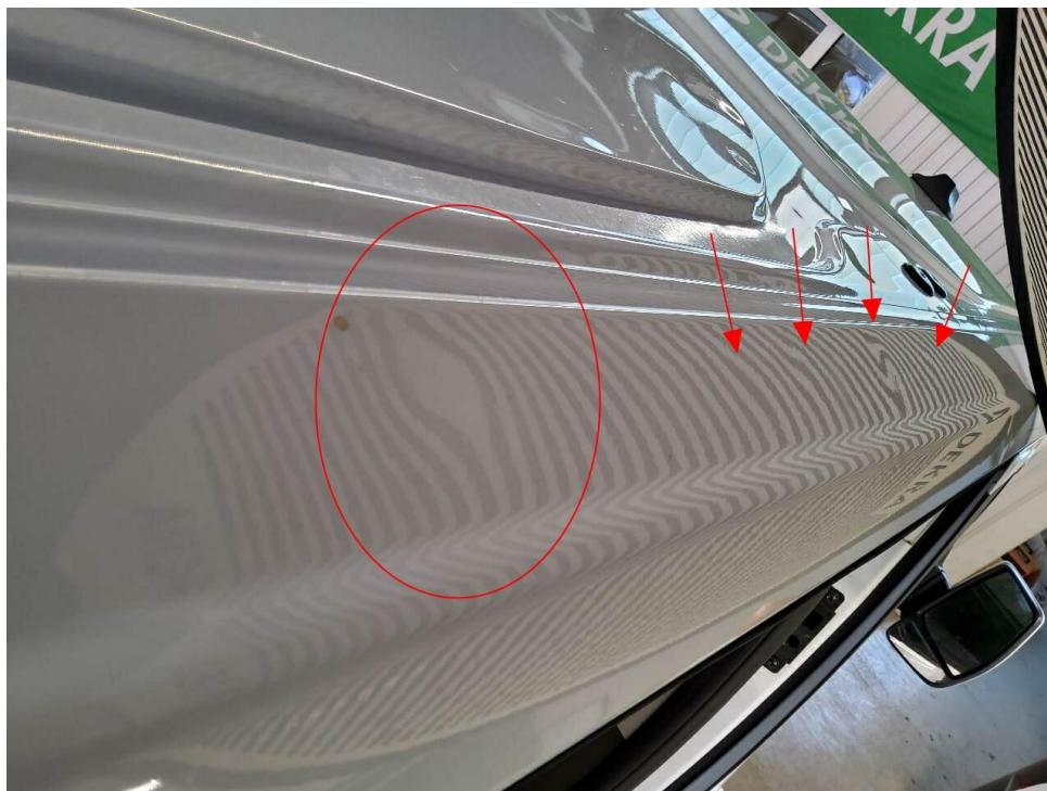
Bild 17 : Dachrahmen rechts, mehrfach eingedellt
