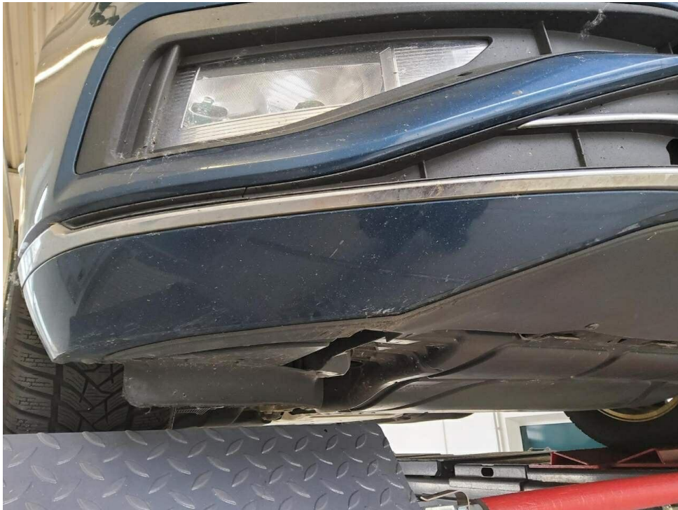
Bild 17 : Frontspoiler Lackierung, verschrammt, Gebrauchsspur
