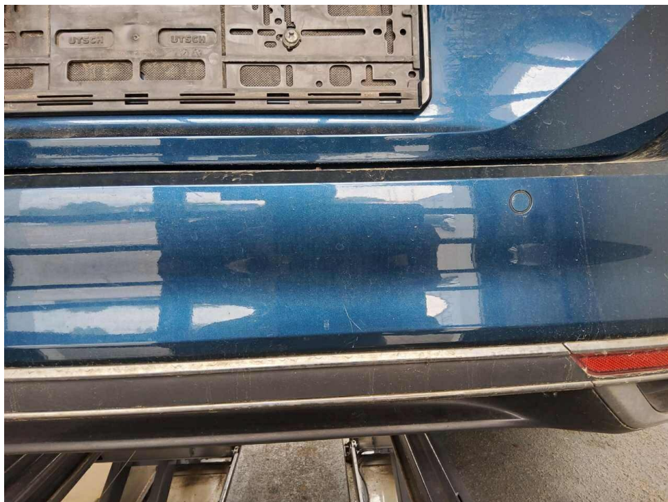
Bild 16 : Stoßfänger hinten Lackierung, verschrammt, Gebrauchsspur
