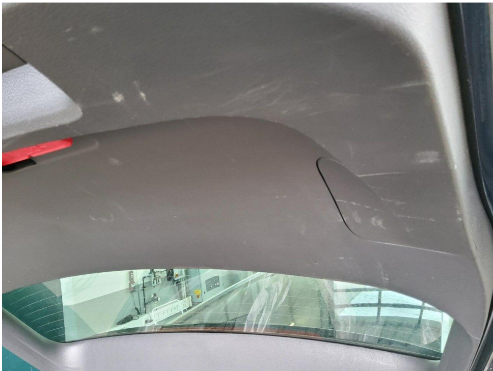
Bild 18 : Verkleidung Heckklappe, verschrammt, Gebrauchsspur
