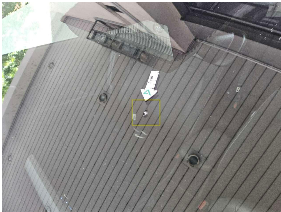
Bild 14 : Frontscheibe, Steinschlag mit Rissbildung
