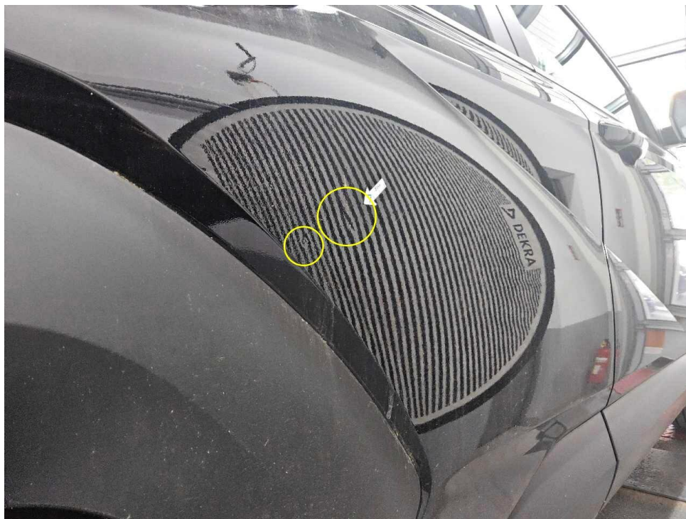
Bild 18 : Tür hinten rechts, eingedellt
