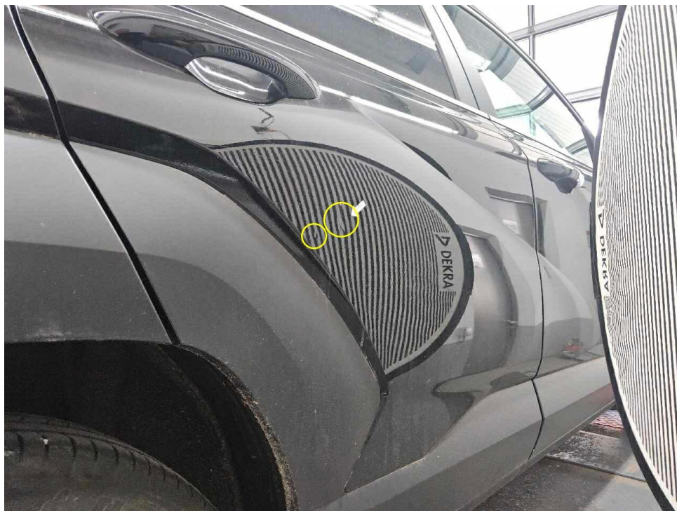
Bild 17 : Tür hinten rechts, eingedellt
