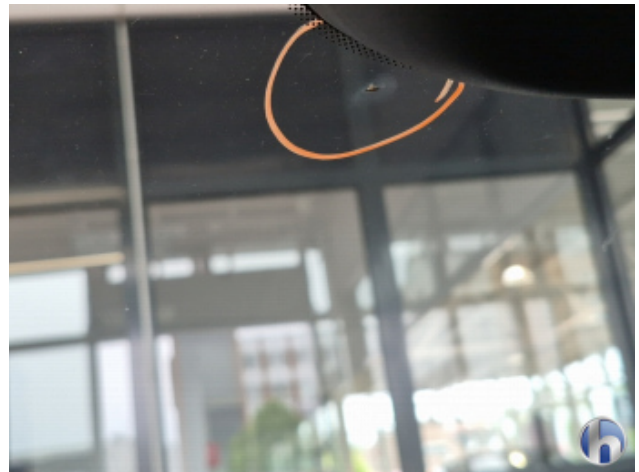
1. Windschutzscheibe Riss - Erneuern
