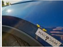
Door FL, Dent(s), Acceptable
