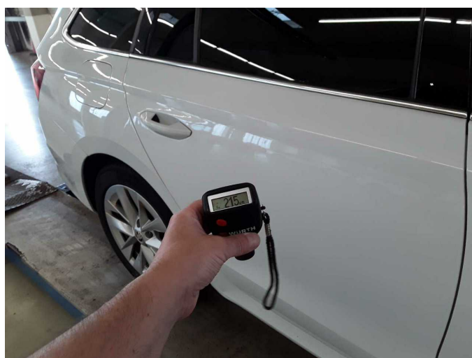
Door - rear right side: 215 \mu\text{m}
