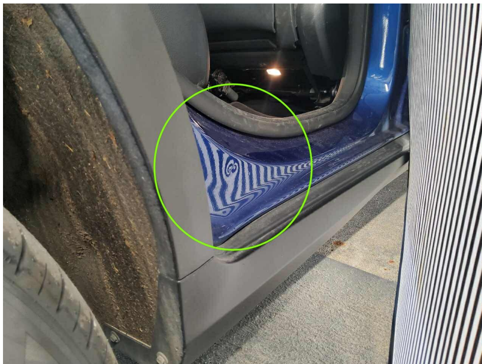
Bild 21 : Einstieg hinten rechts, mehrfach eingedellt mit Lackschaden
