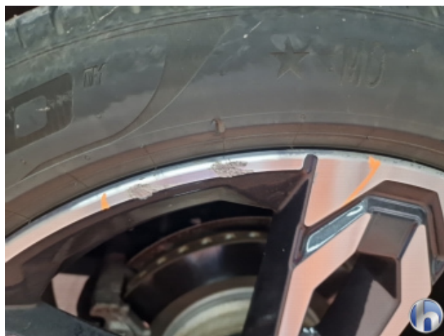
2. Felge Hinten - Rechts Beschädigt - Smart Repair
