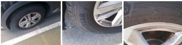
Alloy rim RR, Scratch(es), Repair/replace (lump sum)
