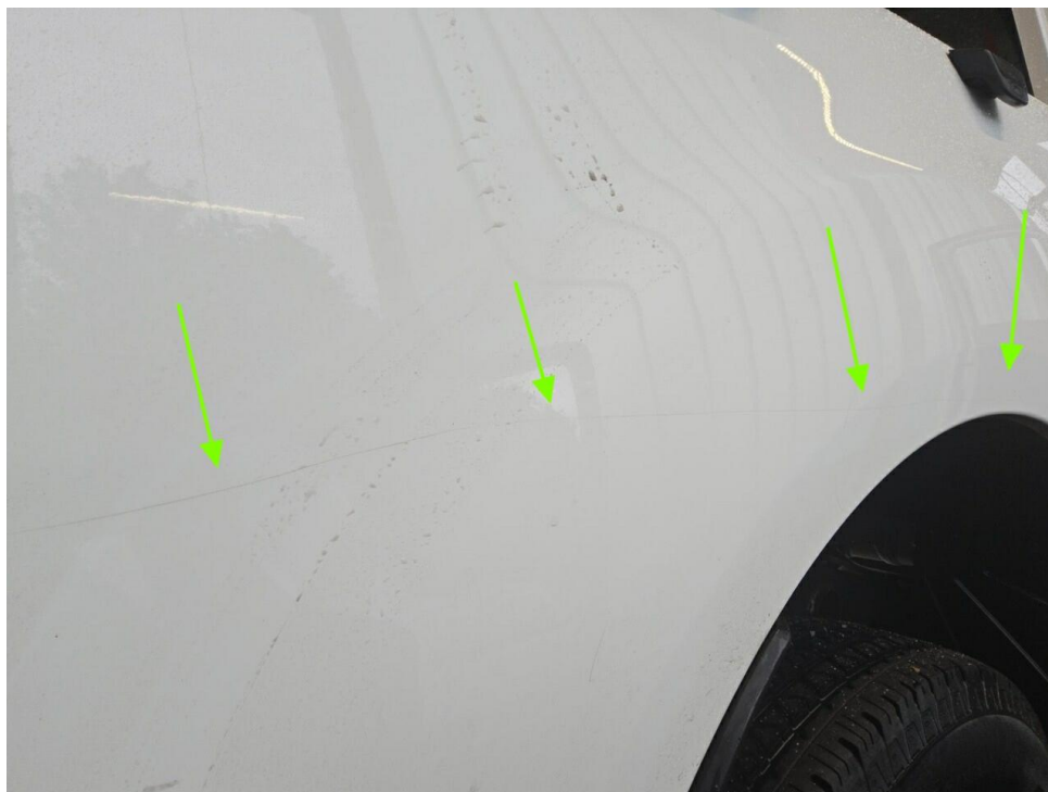
Bild 13 : Bordwand links Lackierung, zerkratzt, lackieren mit Lackaufbau
