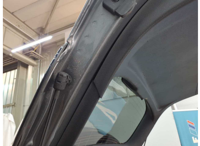
Damage 4: Trim / covers: Boot lid - interior trim (Mit Kratzer) - Deformed - Replace
