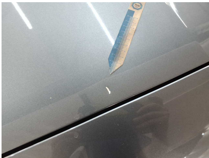
Damage 5: Bonnet: Bonnet (Mit Steinschlag) - Dent / paintcoat damage - Paint
