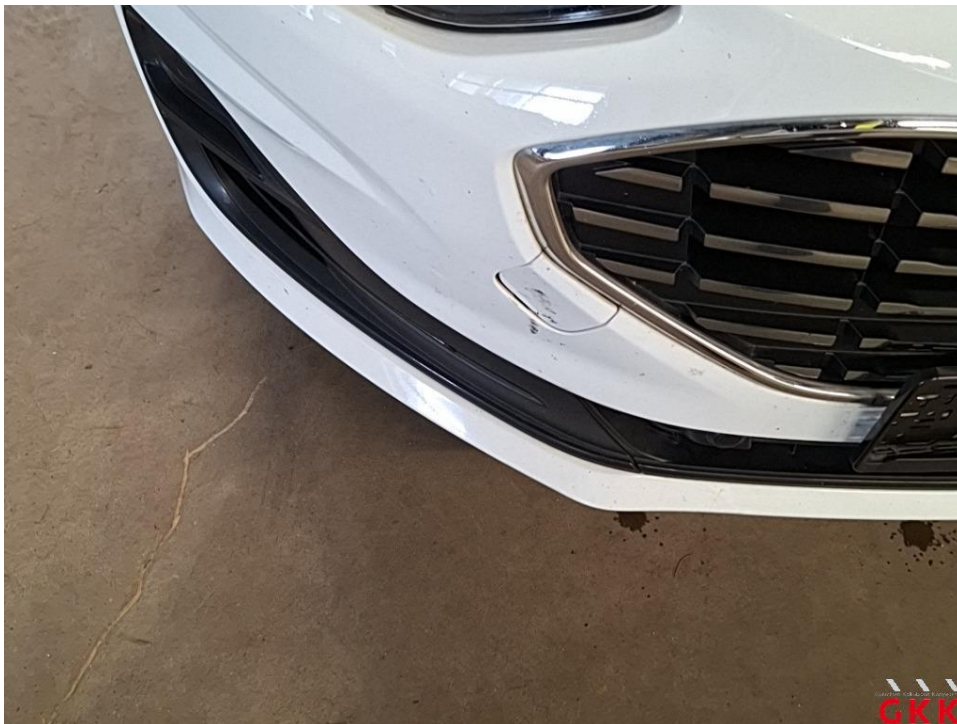
Bild 20 Stoßfänger vorne, Abdeckung Abschlepphaken, beschädigt, ersetzen
