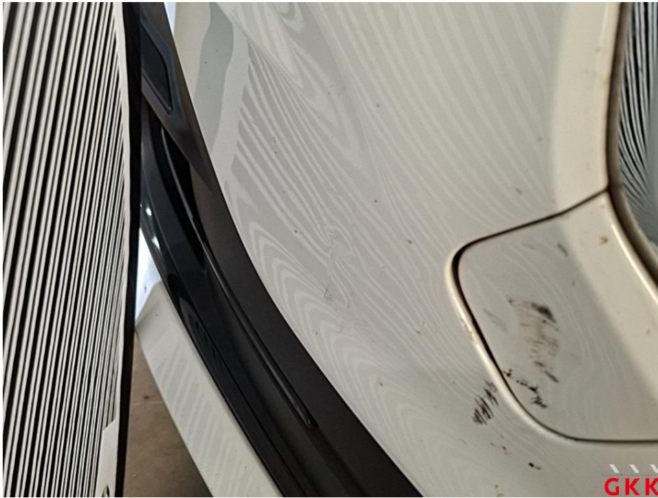
Bild 19 Stoßfänger vorne, Verkleidung -lackiert-, beschädigt, ersetzen
