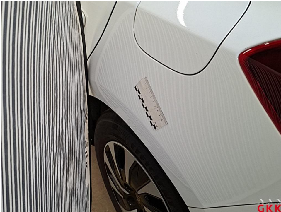
Bild 38 Seitenwand links, beschädigt, instand setzen - lackieren
