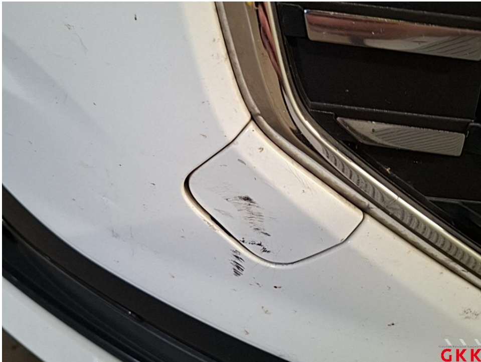
Bild 21 Stoßfänger vorne, Abdeckung Abschlepphaken, beschädigt, ersetzen
