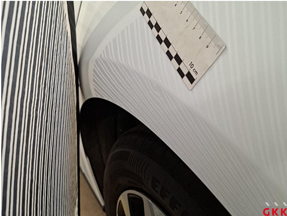
Bild 39 Seitenwand links, beschädigt, instand setzen - lackieren
