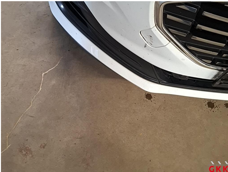
Bild 18 Stoßfänger vorne, Verkleidung -lackiert-, beschädigt, ersetzen
