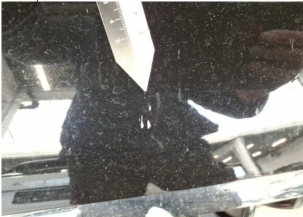
Beschädigung #11: Motorhaube: Motorhaube (Verätzungen und Kratzer) - Korrosion - instandsetzen und lackieren
