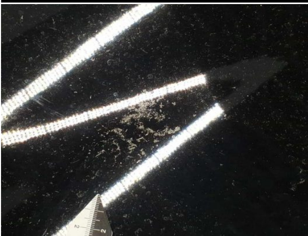
Damage #11: Bonnet: Bonnet (Verätzungen und Kratzer) - Corrosion - Repair and paint
