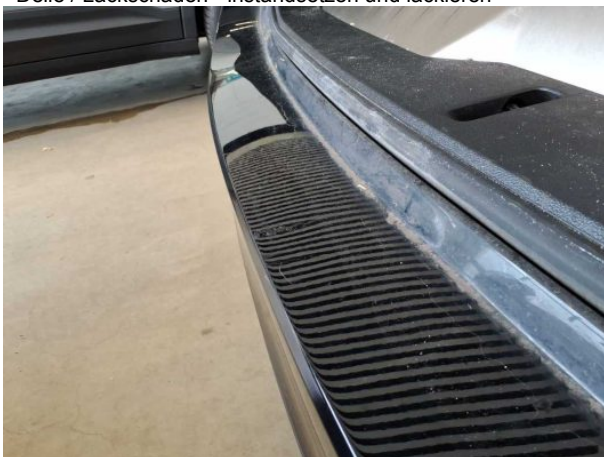
Beschädigung #10: Stossfänger hinten: Stossfänger mit Parktro... - Delle / Lackschaden - instandsetzen und lackieren
