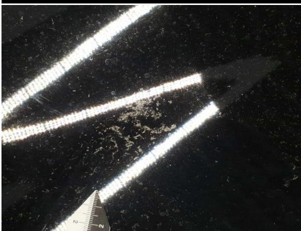
Beschädigung #11: Motorhaube: Motorhaube (Verätzungen und Kratzer) - Korrosion - instandsetzen und lackieren
