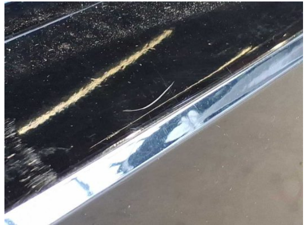
Beschädigung #10: Stossfänger hinten: Stossfänger mit Parktronic - Delle / Lackschaden - instandsetzen und lackieren
