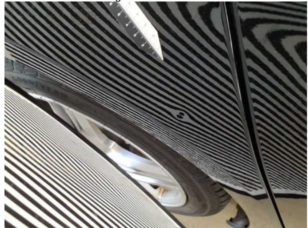
Beschädigung #6: Seitenwand rechts: Seitenwand - Delle(n) - sanft instandsetzen
