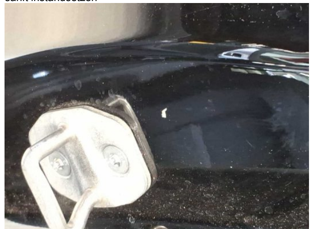
Beschädigung #7: Seitenwand rechts: Einstieg - Kratzer - Smart Repair
