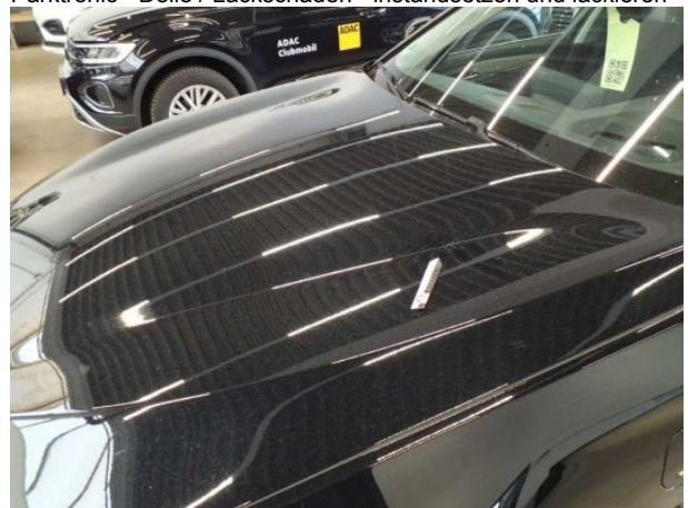
Beschädigung #11: Motorhaube: Motorhaube (Verätzungen und Kratzer) - Korrosion - instandsetzen und lackieren
