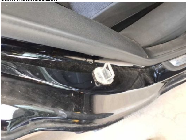
Beschädigung #7: Seitenwand rechts: Einstieg - Kratzer - Smart Repair
