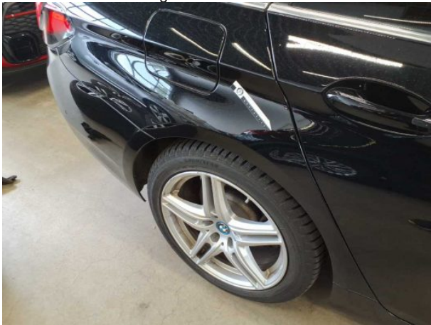
Beschädigung #6: Seitenwand rechts: Seitenwand - Delle(n) - sanft instandsetzen
