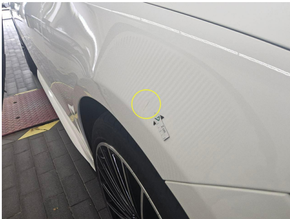
Bild 15 : Kotflügel vorne rechts, eingedellt
