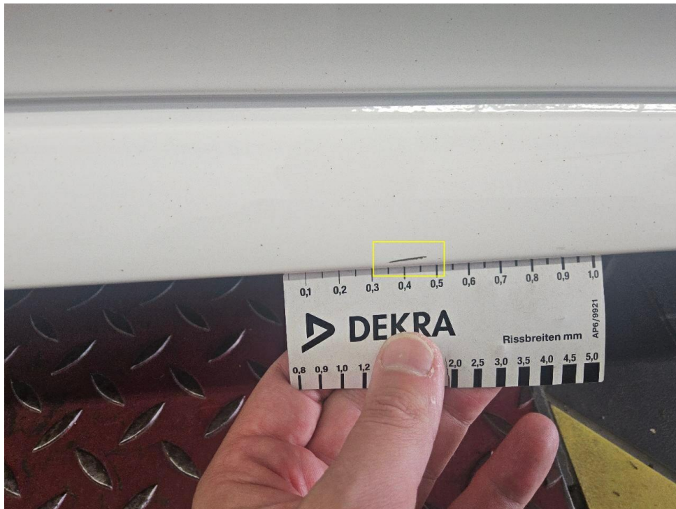
Bild 19 : Schwellerverkleidung rechts, zerkratzt
