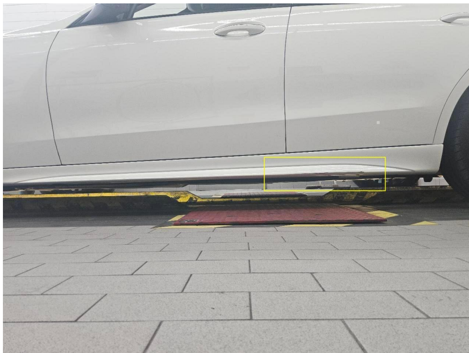
Bild 16 : Schwellerverkleidung links, zerkratzt
