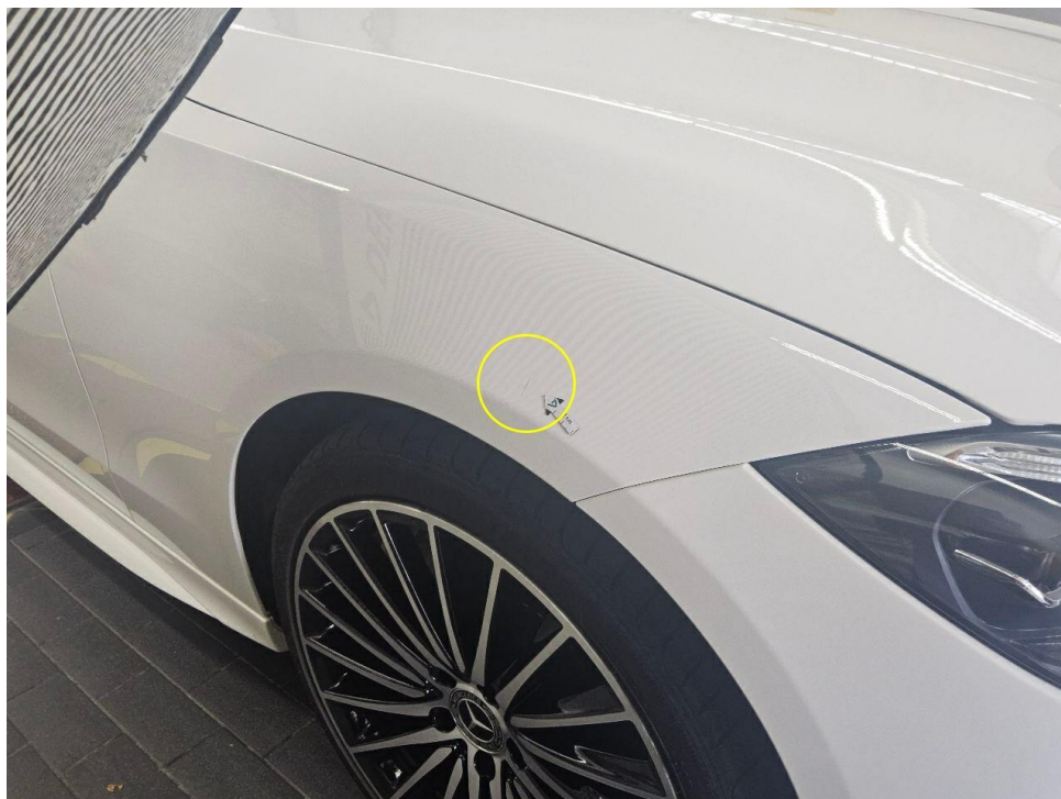
Bild 14 : Kotflügel vorne rechts, eingedellt
