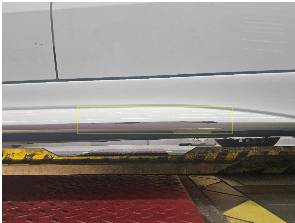
Bild 17 : Schwellerverkleidung links, zerkratzt
