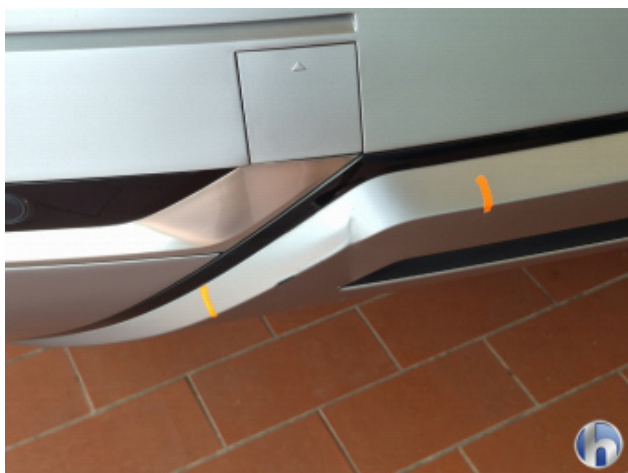
1. Stoßfänger Hinten Beschädigt - Instandsetzen und Lackieren
