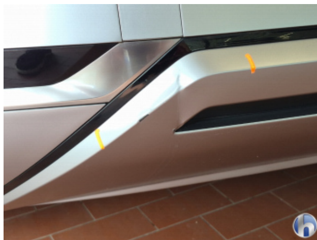
1. Stoßfänger Hinten Beschädigt - Instandsetzen und Lackieren
