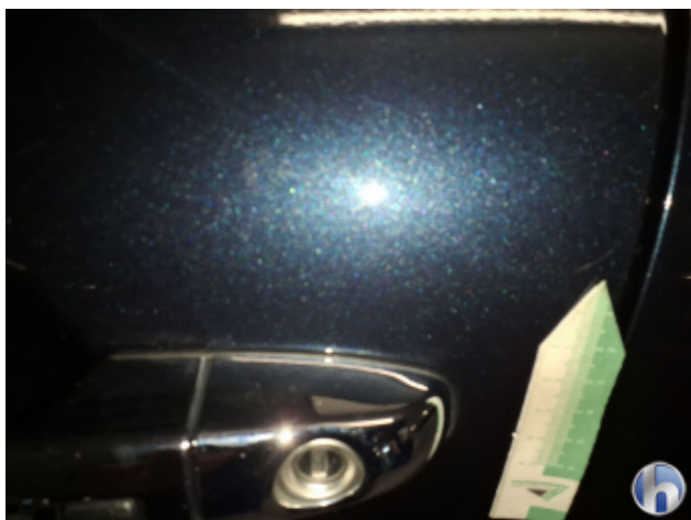
3. Tür Vorne - Links Oberflächenkratzer - Ohne Reparatur
