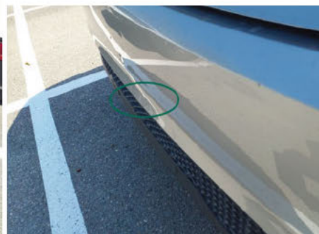
Pare-chocs / Arrière / Enfoncement
