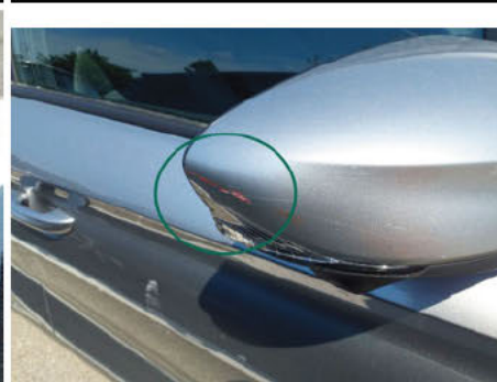
Coquille de rétroviseur / Droit / Rayure
