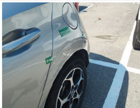
Aile / Arrière Gauche / Enfoncement
