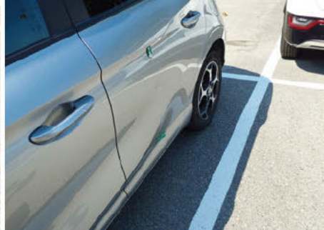
Porte / Arrière Gauche / Enfoncement
