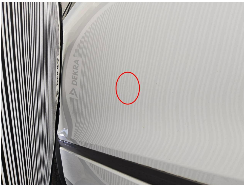
Bild 21 : Tür hinten rechts, eingedellt, drücken
