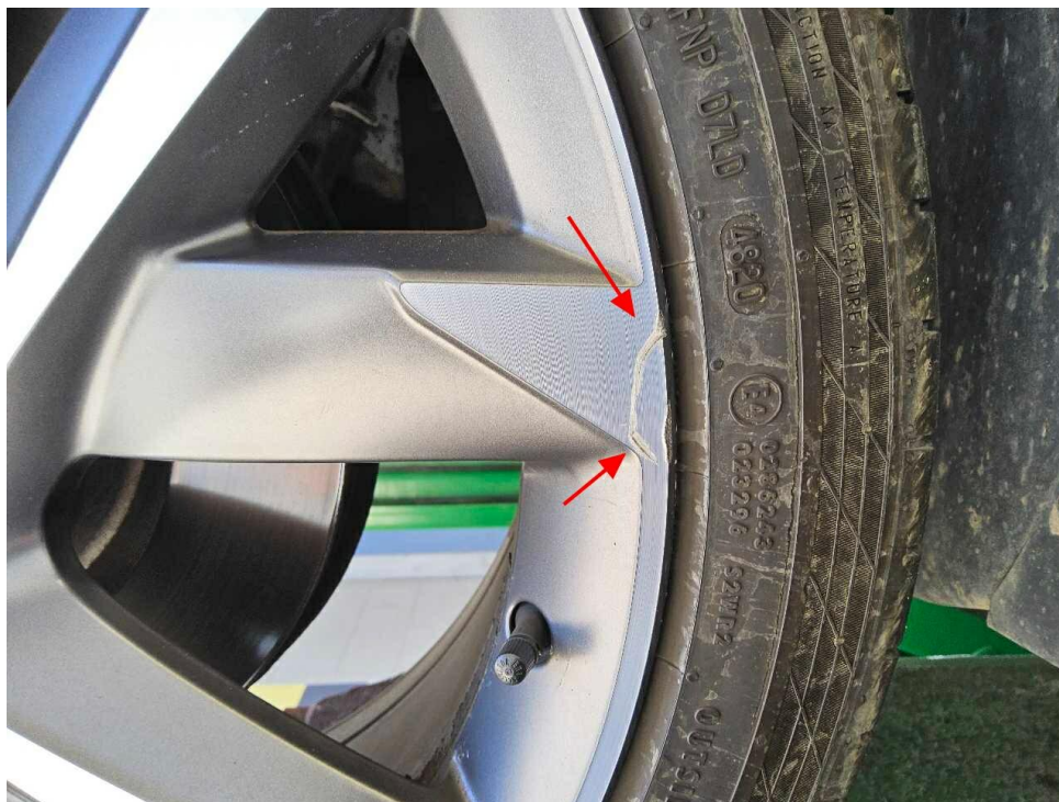
Bild 16 : Leichtmetallfelge (Glanzgedreht) vorn links, verkratzt mit Materialabtrag, ersetzen
