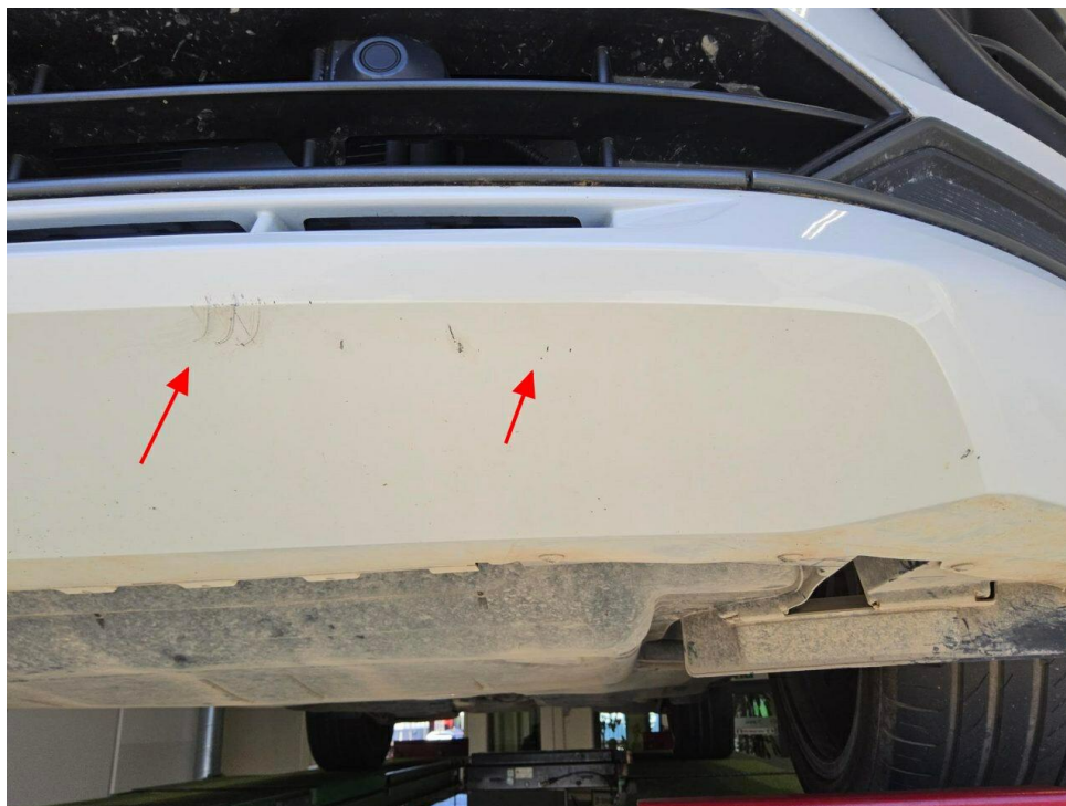
Bild 15 : Frontspoiler Lackierung, zerkratzt, lackieren mit Lackaufbau
