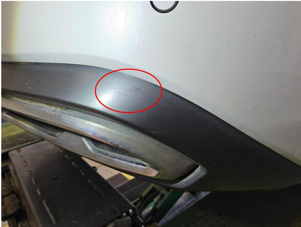
Bild 19 : Heckschürze hinten unten Lackierung, verschrammt, Gebrauchsspur
