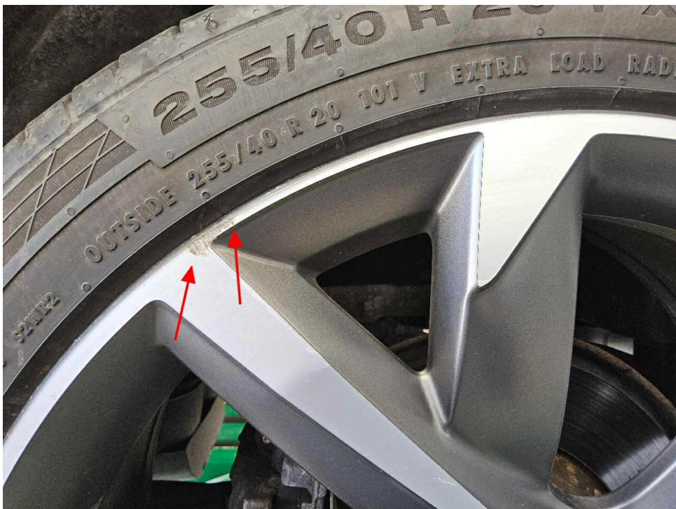
Bild 18 : Leichtmetallfelge (Glanzgedreht) hinten links, verkratzt mit Materialabtrag, ersetzen
