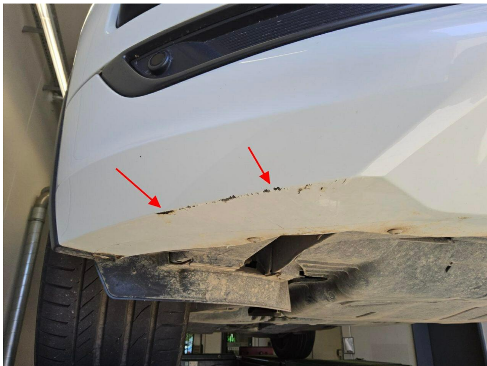
Bild 14 : Frontspoiler Lackierung, zerkratzt, lackieren mit Lackaufbau
