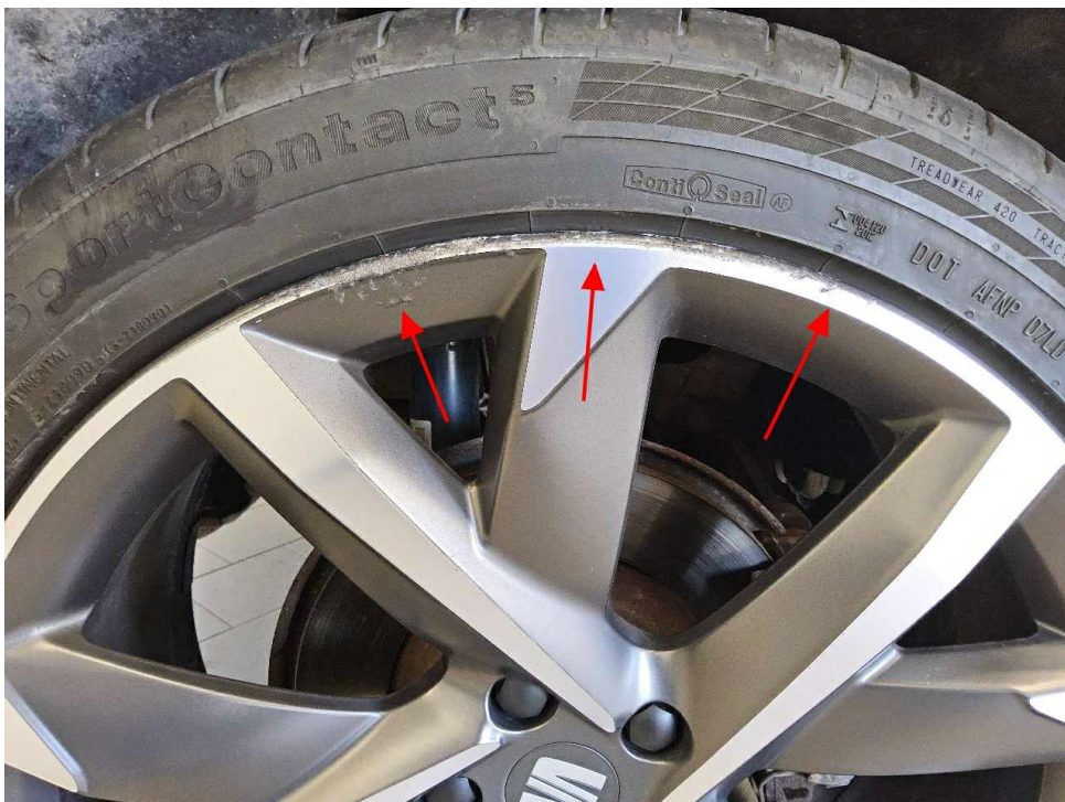
Bild 20 : Leichtmetallfelge (Glanzgedreht) hinten rechts, verkratzt mit Materialabtrag, ersetzen
