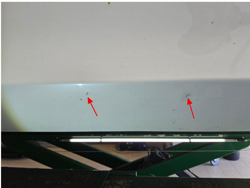
Bild 22 : Tür vorne rechts Schutzleiste unten Lackierung, verschrammt, Gebrauchsspur
