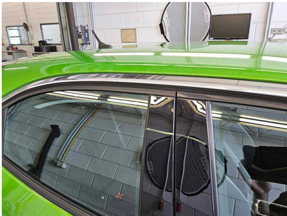
Bild 16 : Zierleisten Fensterrahmen B-Säule links und rechts eingedellt
