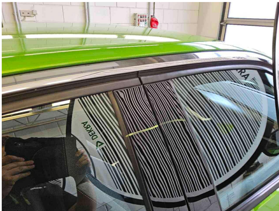
Bild 17 : Zierleisten Fensterrahmen B-Säule links und rechts eingedellt
