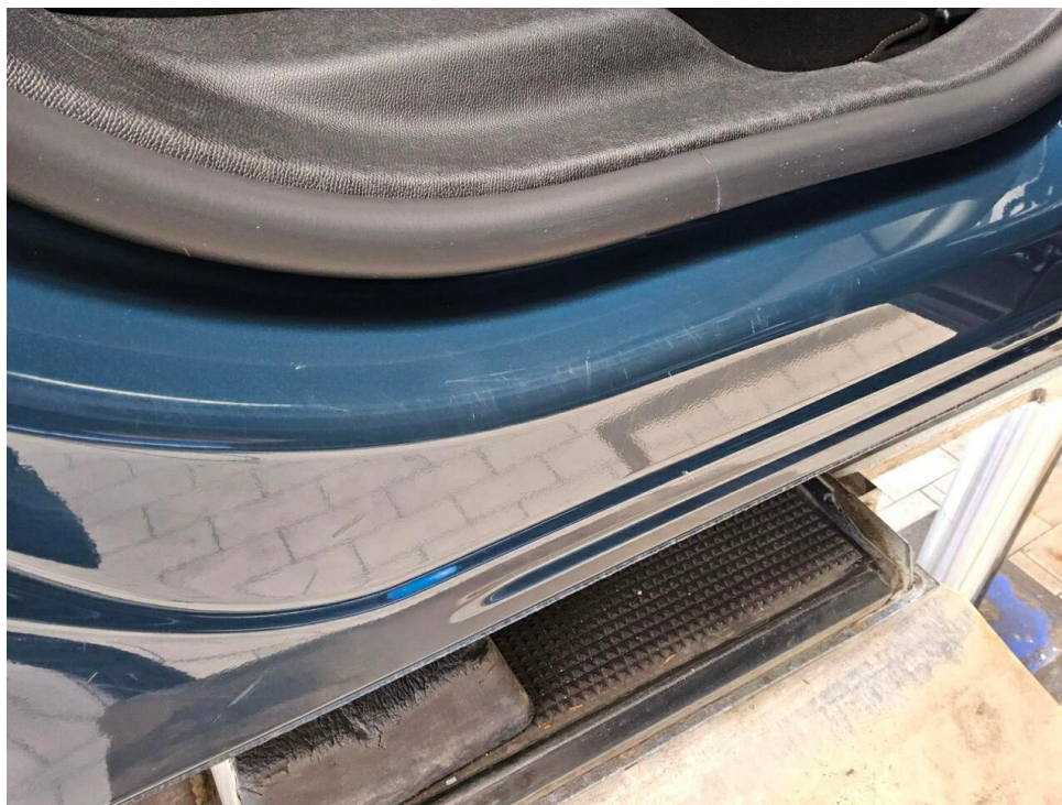
Bild 10 : Tür hinten rechts Einstieg Lackierung, zerkratzt, Gebrauchsspur
