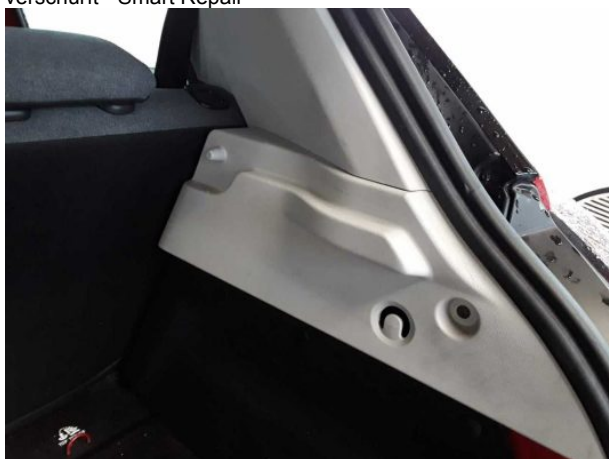
Beschädigung #6: Interieur: Hutablage (Fehlt) - erneuern
