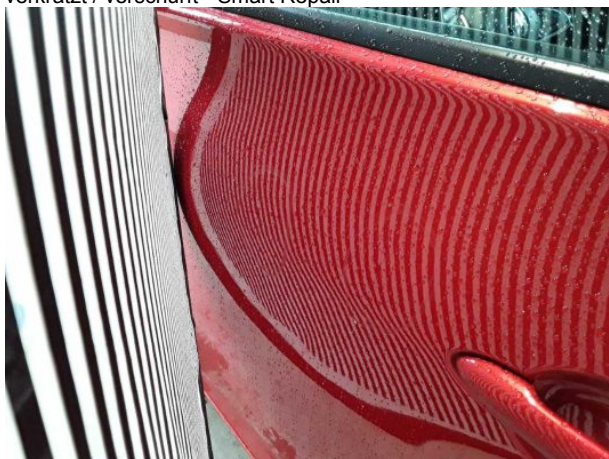
Beschädigung #8: Tür vorn links: Tür (2 Stück) - Delle(n) - sanft instandsetzen
