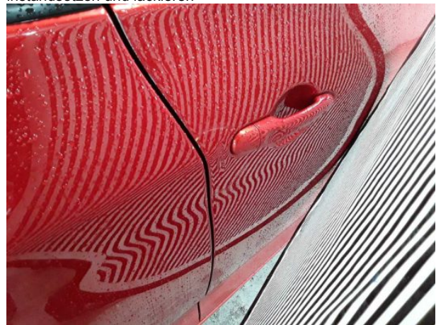
Beschädigung #15: Tür vorn rechts: Tür - verformt - instandsetzen und lackieren
