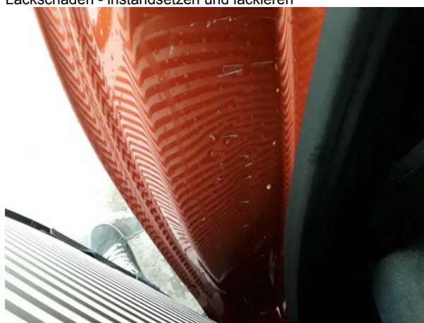
Beschädigung #11: Seitenwand rechts: Einstieg - Delle / Lackschaden - instandsetzen und lackieren
