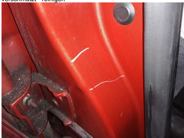
Beschädigung #2: Schweller rechts: Einstieg - verkratzt / verschürft - Smart Repair
