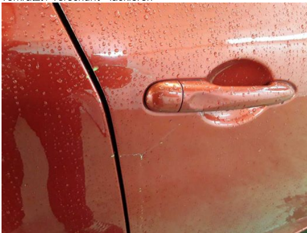
Beschädigung #15: Tür vorn rechts: Tür - verformt - instandsetzen und lackieren
