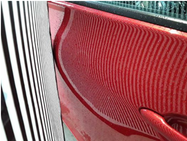
Damage #8: Door - front left side: Door (2 Stück) - dent(s) - Smooth repair work
