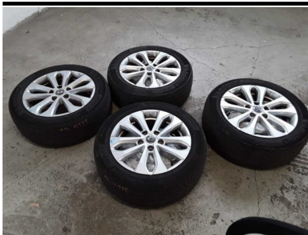
Beschädigung #10: 2.Radsatz: 2 Reifen - verschlissen - erneuern
