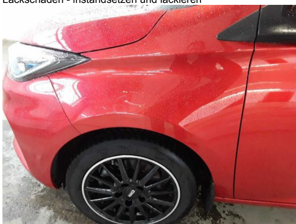
Beschädigung #13: Kotflügel links: Kotflügel links - verkratzt / verschürft - lackieren
