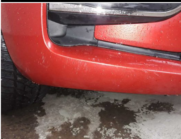
Beschädigung #14: Stossfänger vorn: Stossfänger vorn - verkratzt / verschürft - lackieren
