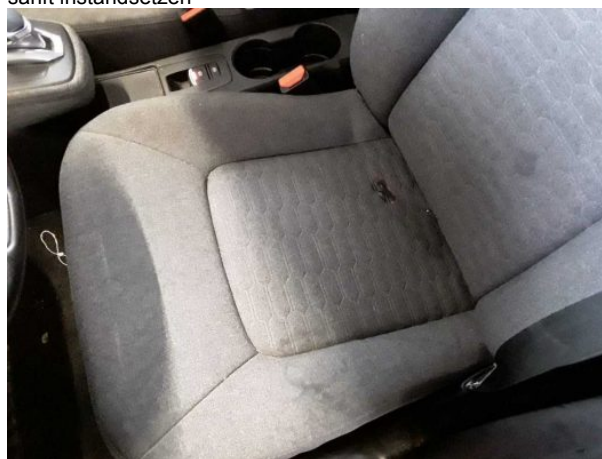
Beschädigung #9: Sitz vorn: Sitzbezug links - beschädigt - erneuern
