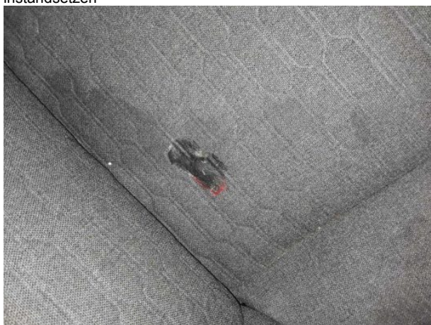
Beschädigung #9: Sitz vorn: Sitzbezug links - beschädigt - erneuern
