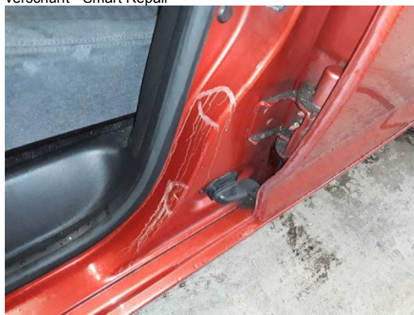
Beschädigung #3: Schweller links: Einstieg - verkratzt / verschürft - Smart Repair
