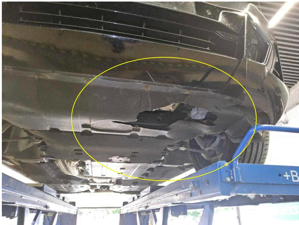
Bild 36 : Schaden Unterboden, Unterfahrschutz gebrochen
