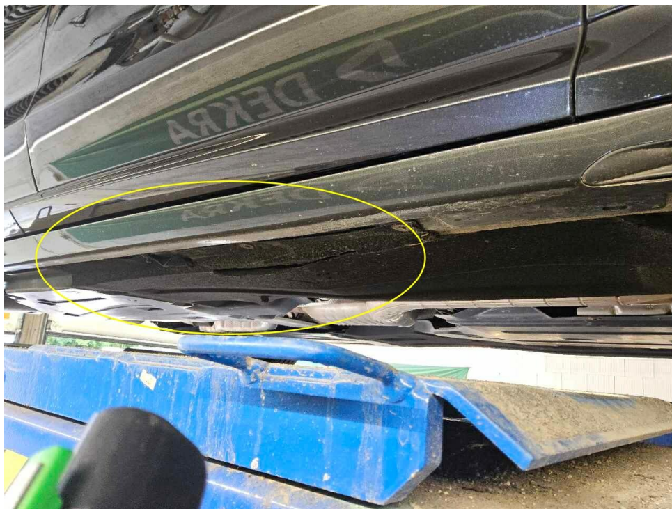
Bild 42 : Schaden Unterboden, Unterfahrschutz gebrochen
