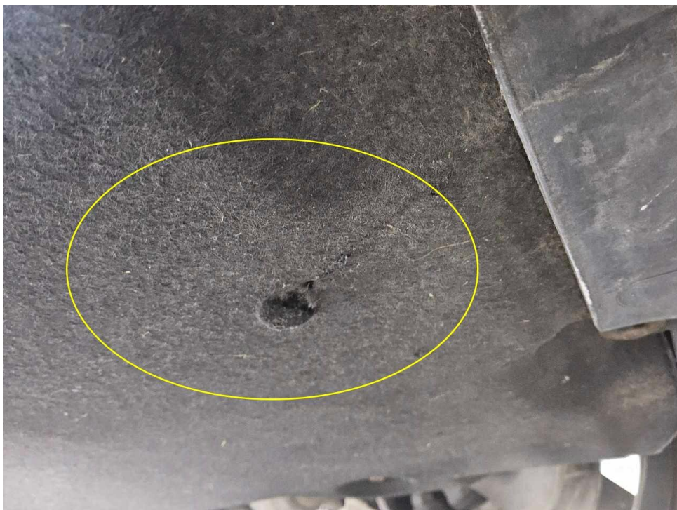
Bild 40 : Schaden Unterboden, Unterfahrschutz gebrochen
