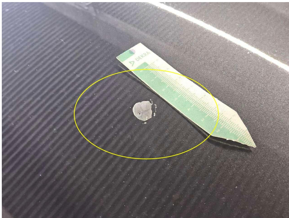
Bild 22 : Dach Lackierung, Umweltschaden, lackieren mit Lackaufbau
