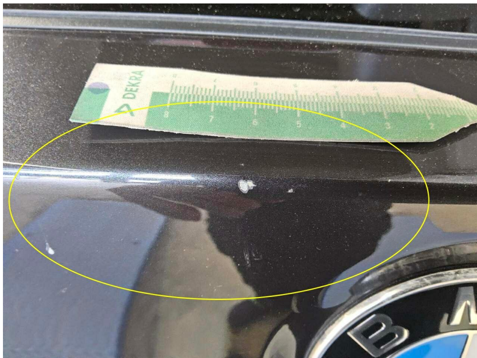
Bild 26 : Heckklappe Lackierung, zerkratzt, smart repair
