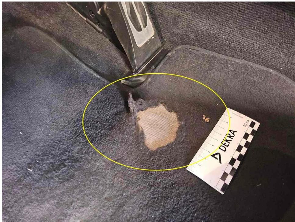
Bild 31 : Fußmatte vorne links ingerissen
