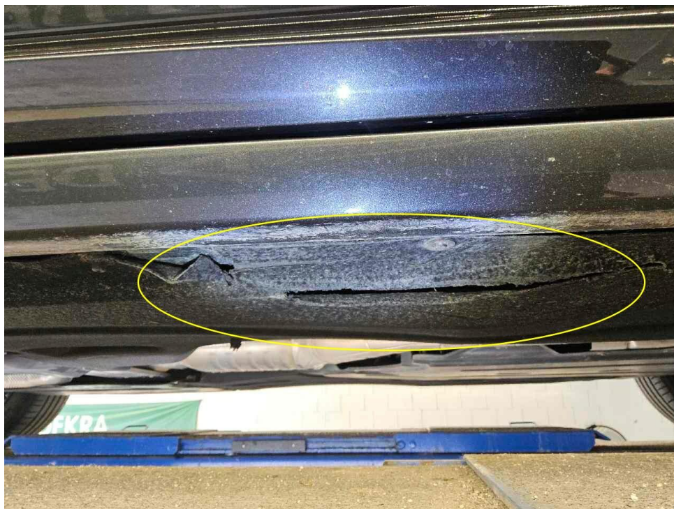
Bild 41 : Schaden Unterboden, Unterfahrschutz gebrochen
