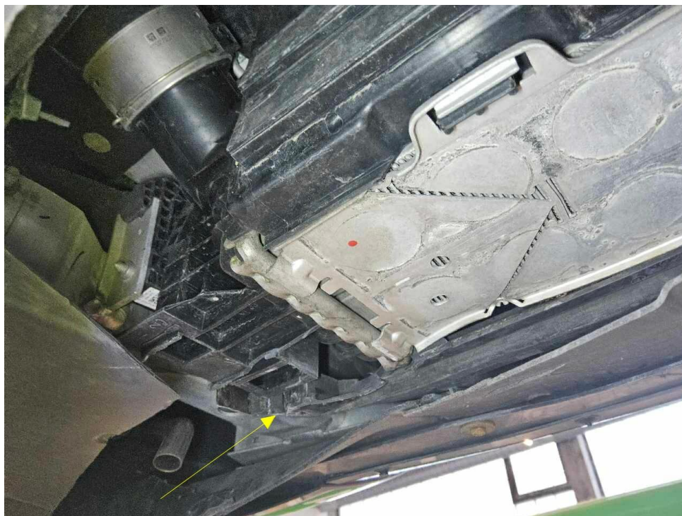
Bild 38 : Schaden Unterboden, Unterfahrschutz gebrochen
