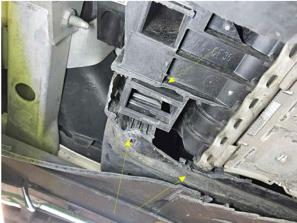
Bild 39 : Schaden Unterboden, Unterfahrschutz gebrochen
