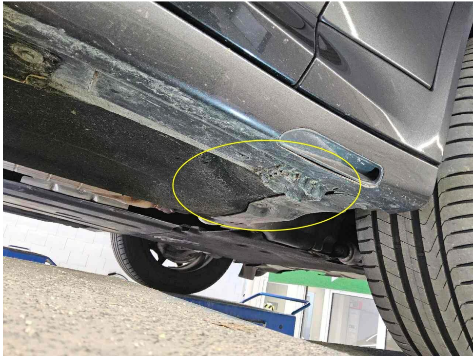
Bild 43 : Schaden Unterboden, Unterfahrschutz gebrochen
