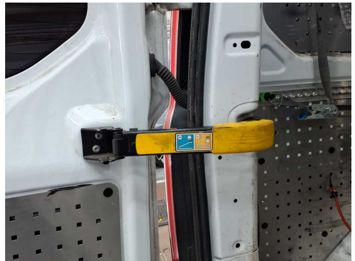
Damage 1: Boot lid / rear door: Rear door - left side (Öffnet sehr schwergängig) - Perform diagnosis
