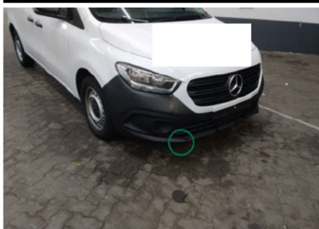
Stoßfänger unterhalb / Vorne / Delle
