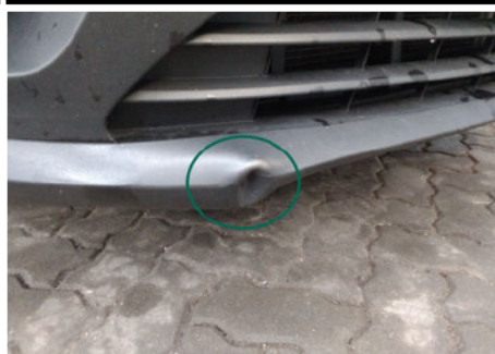
Stoßfänger unterhalb / Vorne / Delle
