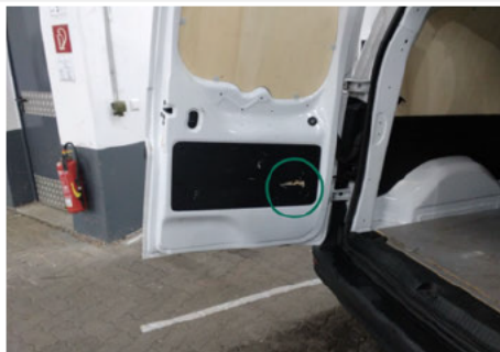
Innenverkleidung Laderaum / Unten Hinten Links / Gebrochen
