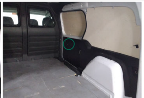
Innenverkleidung Laderaum / Unten Vorne Rechts / Gebrochen
