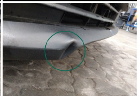
Stoßfänger unterhalb / Vorne / Delle
