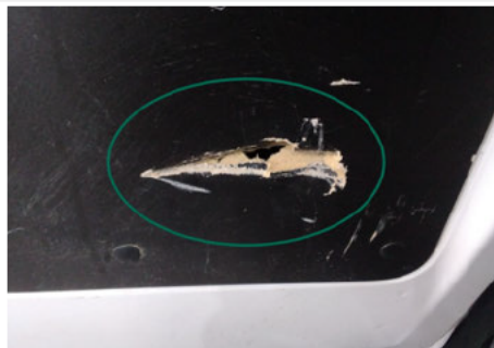
Innenverkleidung Laderaum / Unten Hinten Links / Gebrochen
