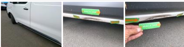
Door trim FL, Scratch(es), Replace
