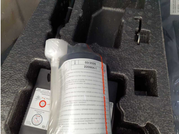
Beschädigung #1: Ausrüstung: Tirefit Füllmittel - abgelaufen - erneuern
