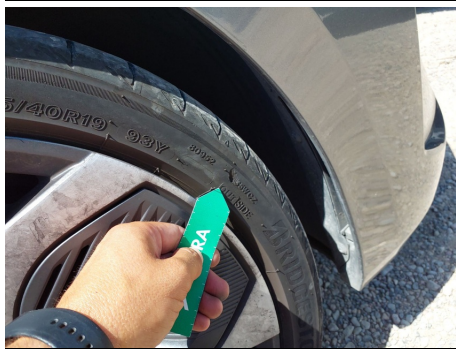
Neumático / Delantero Derecho / Desgarro
