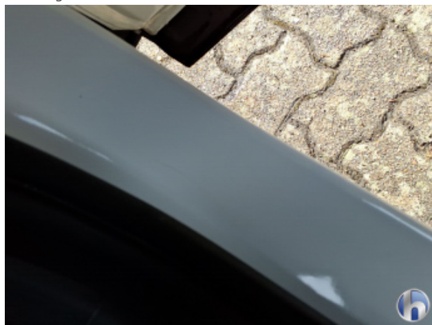
1. Schweller - Rechts Oberflächenkratzer - Aufbereiten / Polieren
