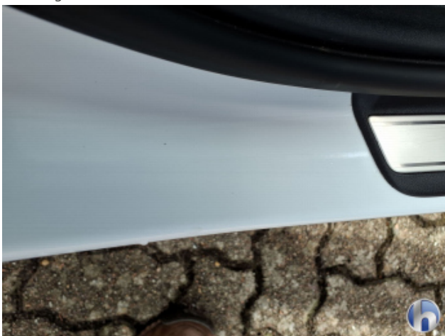
1. Schweller - Rechts Oberflächenkratzer - Aufbereiten / Polieren
