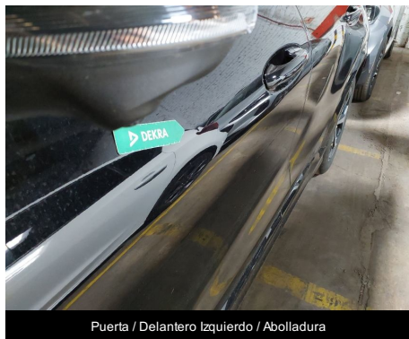
Puerta / Delantero izquierdo / Abolladura
