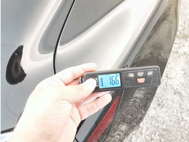
Nacklackierung 1: Kotflügel links, Seitenwand rechts
