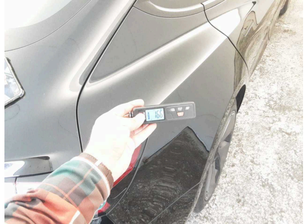
Nacklackierung 1: Kotflügel links, Seitenwand rechts
