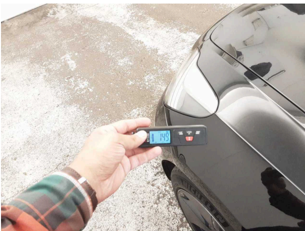
Nacklackierung 1: Kotflügel links, Seitenwand rechts
