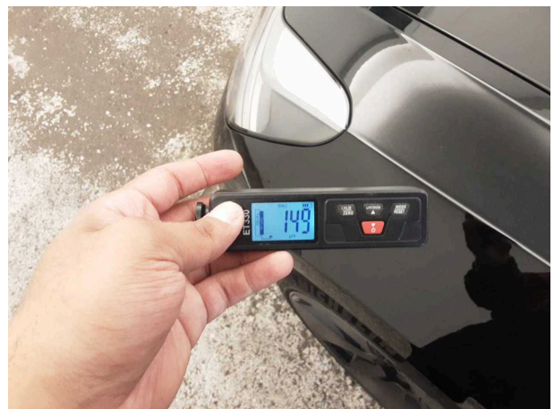
Nacklackierung 1: Kotflügel links, Seitenwand rechts
