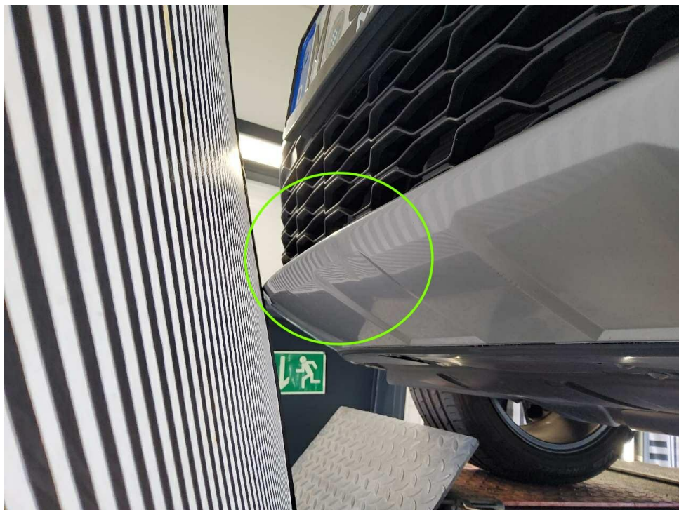
Bild 18 : Stoßfängerabdeckung vorne Unterteil, verschrammt und deformiert
