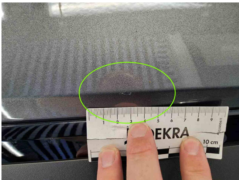
Bild 16 : Tür vorne rechts, verschrammt
