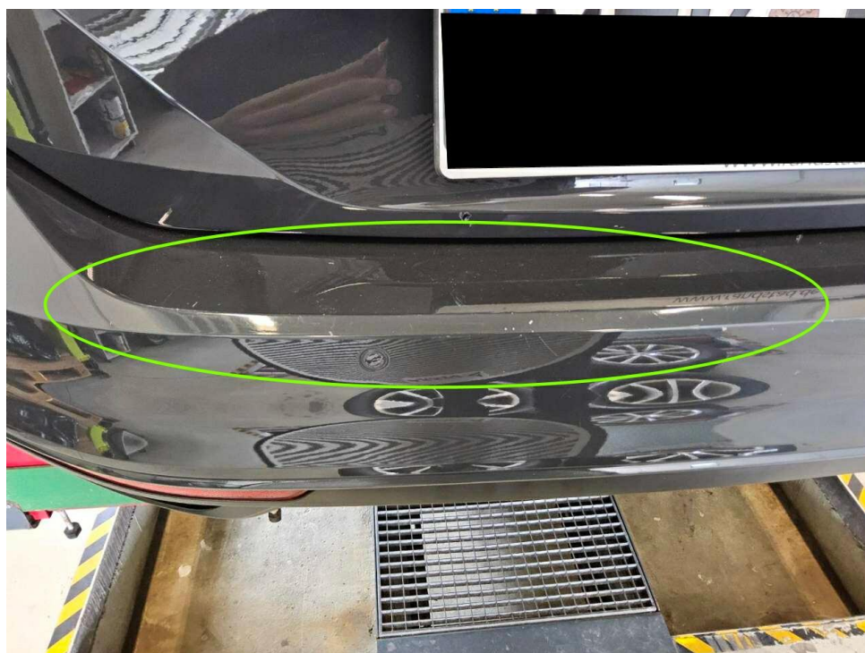
Bild 18 : Stoßfänger hinten, zerkratzt, lackieren
