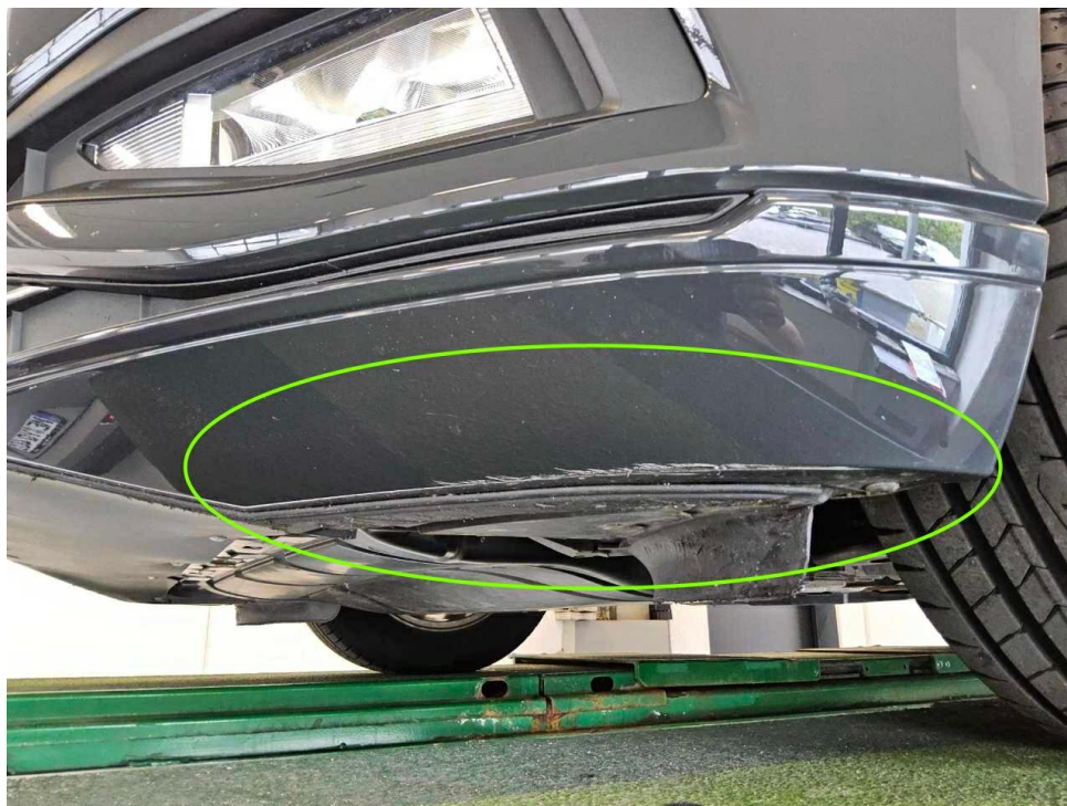
Bild 23 : Frontspoiler, zerkratzt, lackieren mit Lackaufbau
