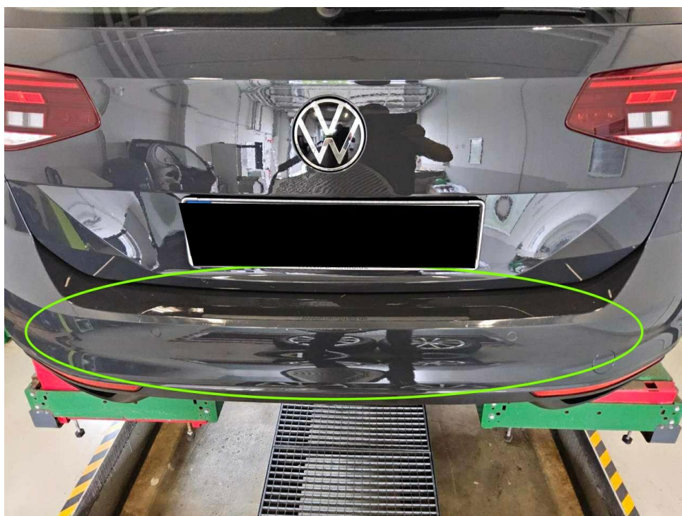
Bild 16 : Stoßfänger hinten, zerkratzt, lackieren
