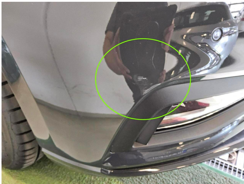
Bild 14 : Stoßfänger vorne, zerkratzt, smart repair
