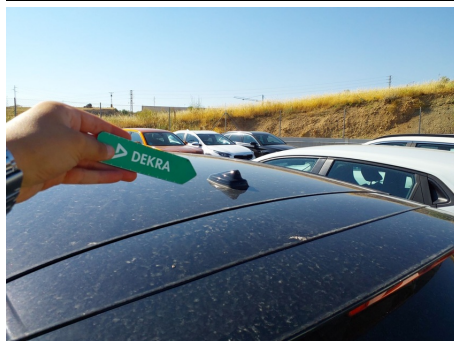
Cable de antena / - / Faltante
