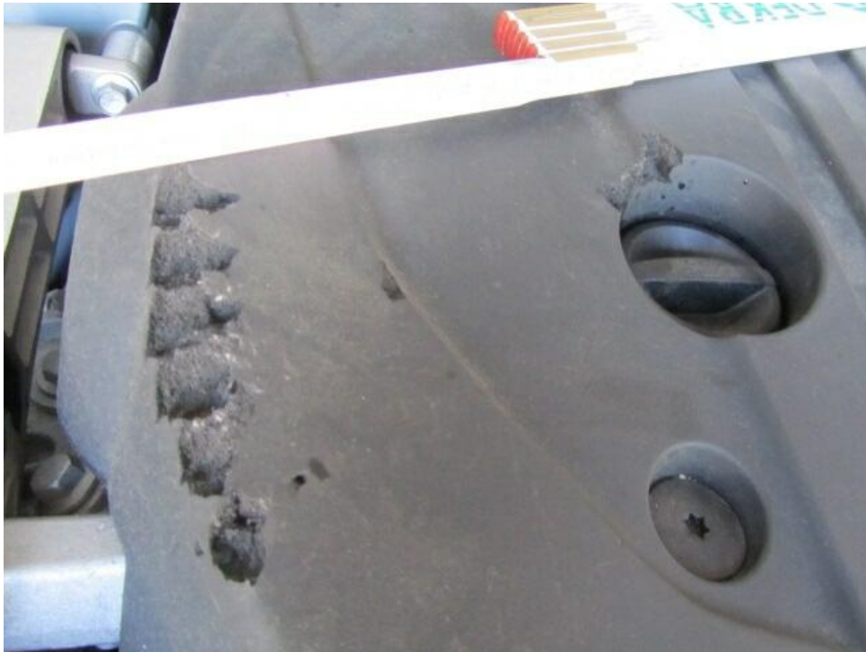
Bild 13 : Motorraum Motorabdeckung, Dichtungen Marderschaden
