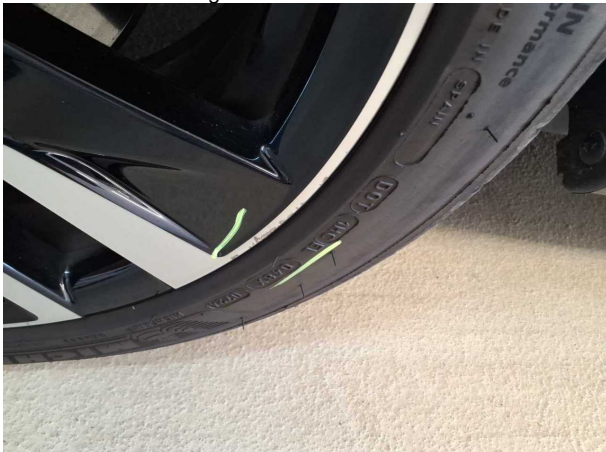
Beschädigung #3: Rad/Reifen: Leichtmetallfelge vorn links - verkratzt / verschürft - Wertminderung
